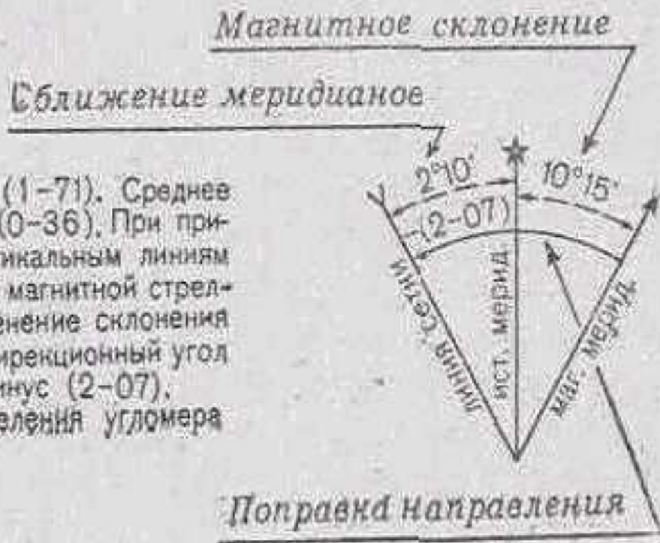
Рис. 31. Схема магнитного склонения, сближения меридианов и поправки направления
