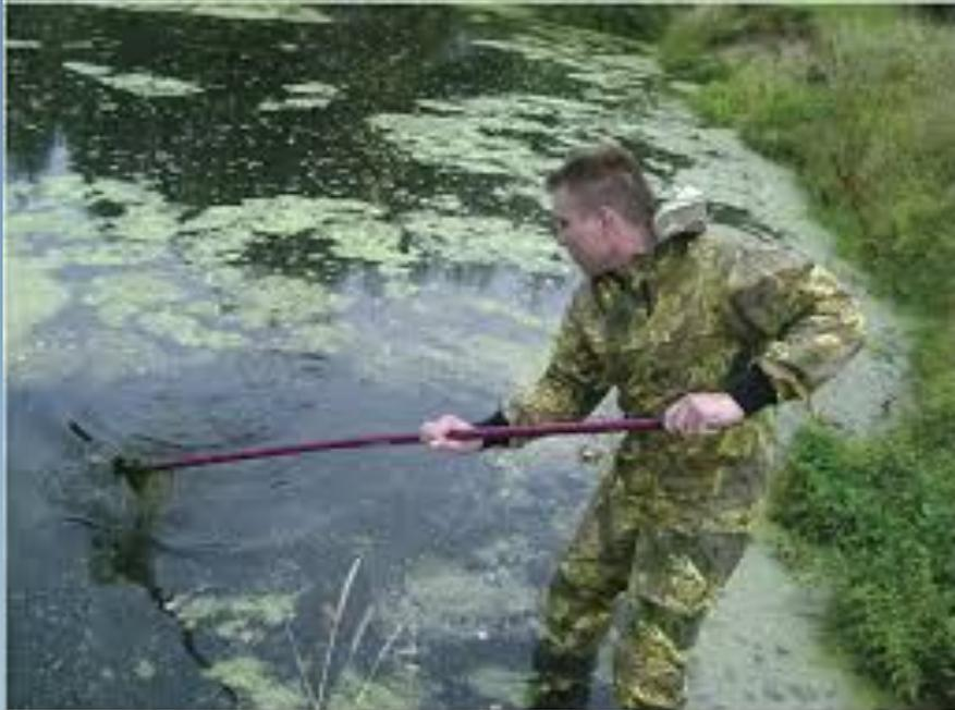
*При отборе проб в районе брода* в узких и мелких реках неизбежно нарушаются придонные слои вод. Поэтому оператор должен входить в воду ниже по течению от точки отбора.
