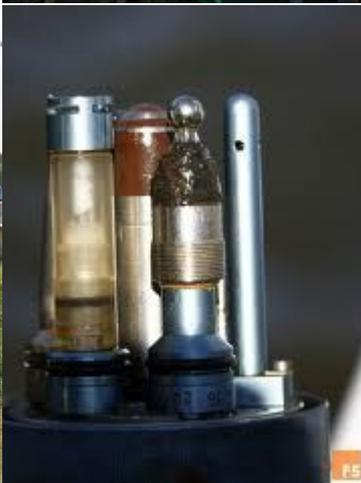
*Отбор проб для проведения химико-аналитического и радиологического контроля качества воды.* Пробы отбирают в ёмкости, изготовленные из химически стойкого стекла с притёртыми пробками или из полимерных материалов, разрешённых для контакта с водой. Допускается использовать корковые или полиэтиленовые пробки.
