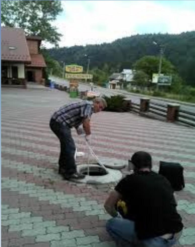
*Отбор проб из распределительной сети* проводят из уличных водоразборных устройств на основных магистральных линиях, на наиболее возвышенных и тупиковых её участках, а также из кранов внутренних водопроводных сетей, гидрантов.
