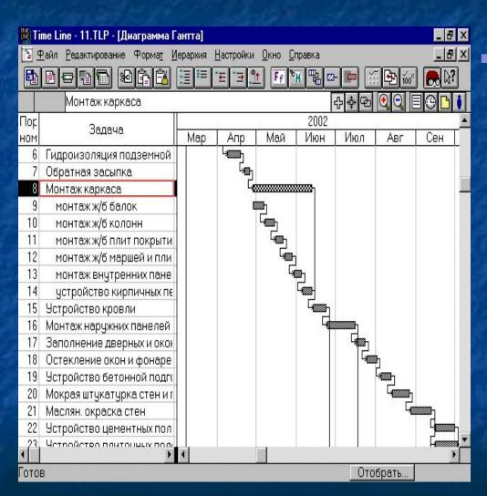
После настройки электронной таблицы вводятся все работы проекта, указывается их продолжительность и взаимосвязи между ними. В результате автоматически строится линейный график Гантта
