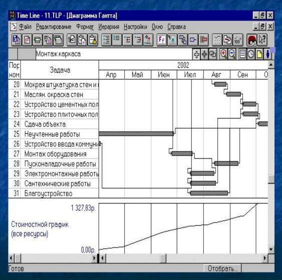
С помощью тех же действий можно вызвать на экран стоимостной график (S-кривую) по всем ресурсам/затратам, получаемую нарастающим итогом
