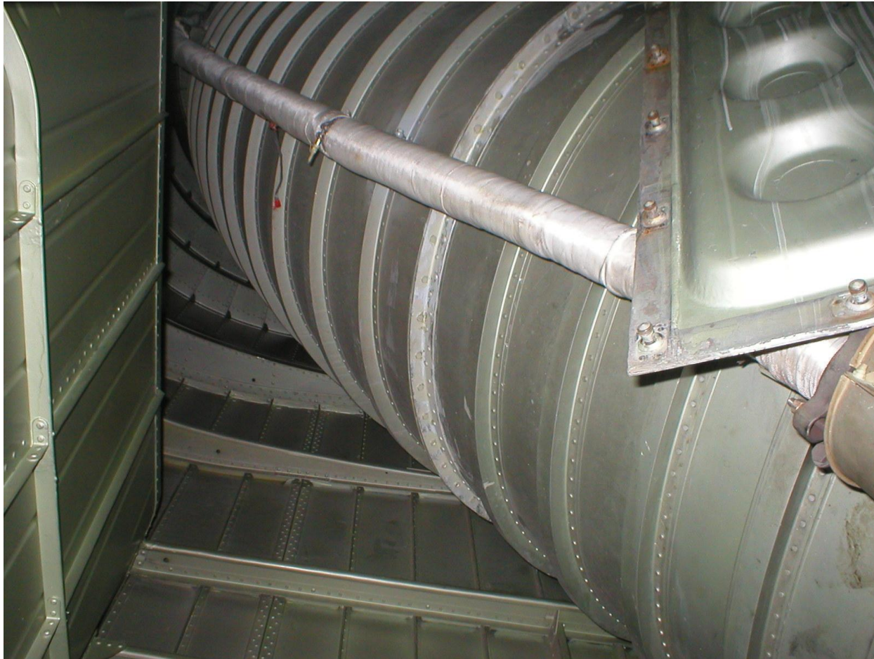
Рис. Пример использования операции листовой штамповки вытяжка на конструктивном элементе самолета Ту-154
