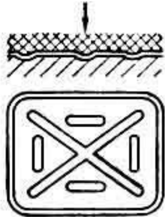
Рис. Схема формовки ребер жесткости
