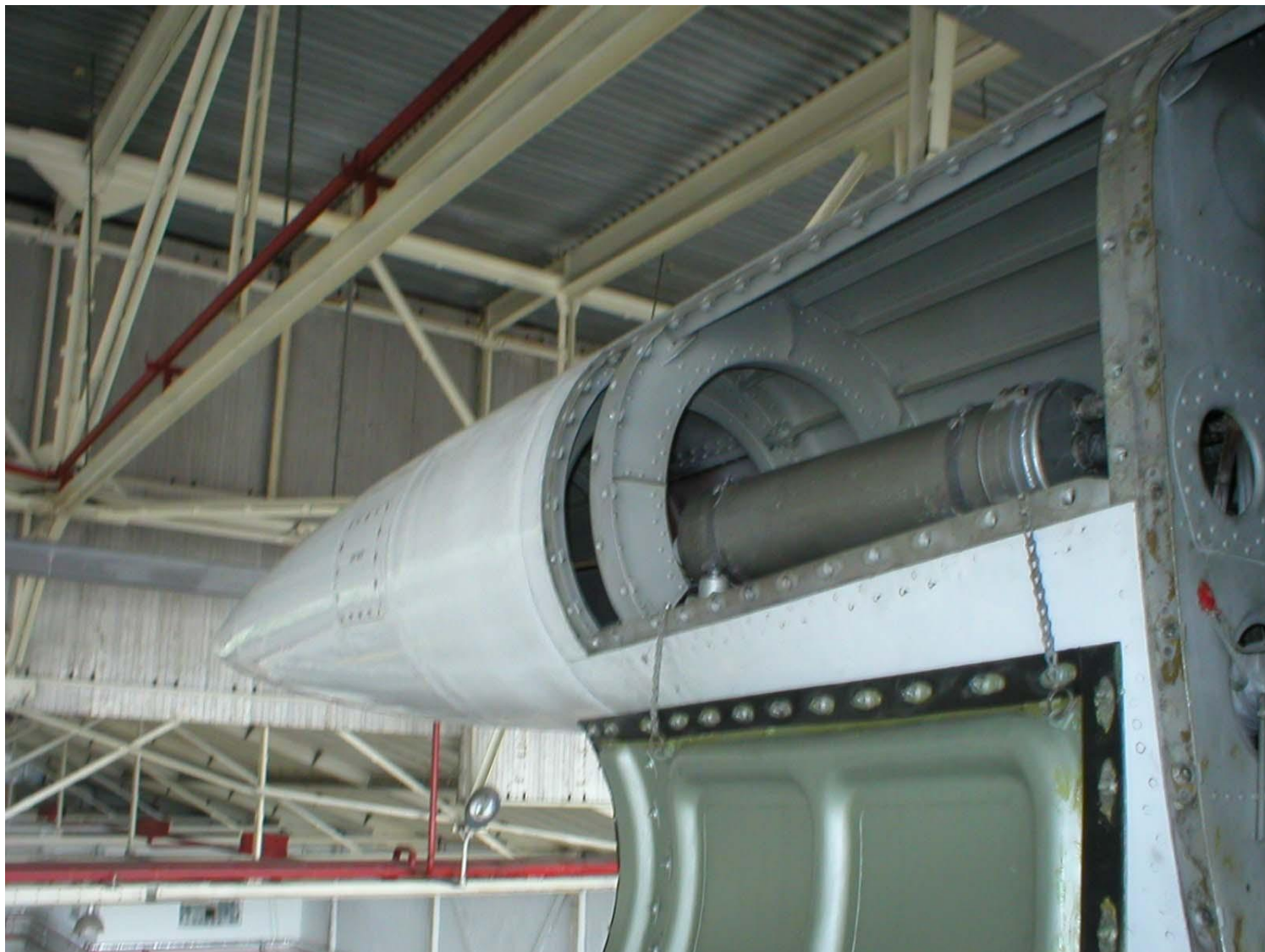
Рис. Пример использования формовки ребер жесткости на внутренней обшивке съемной панели обтекателя стабилизатора самолета Ту-154
