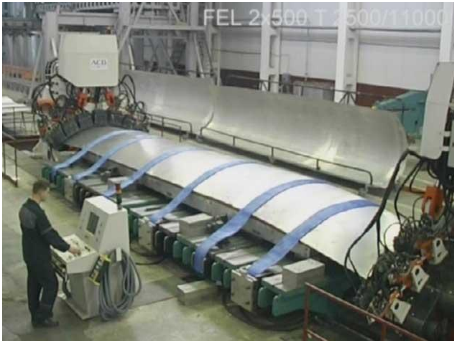
Рис. 8-ми осевой пресс поперечной обтяжки с ЧПУ
