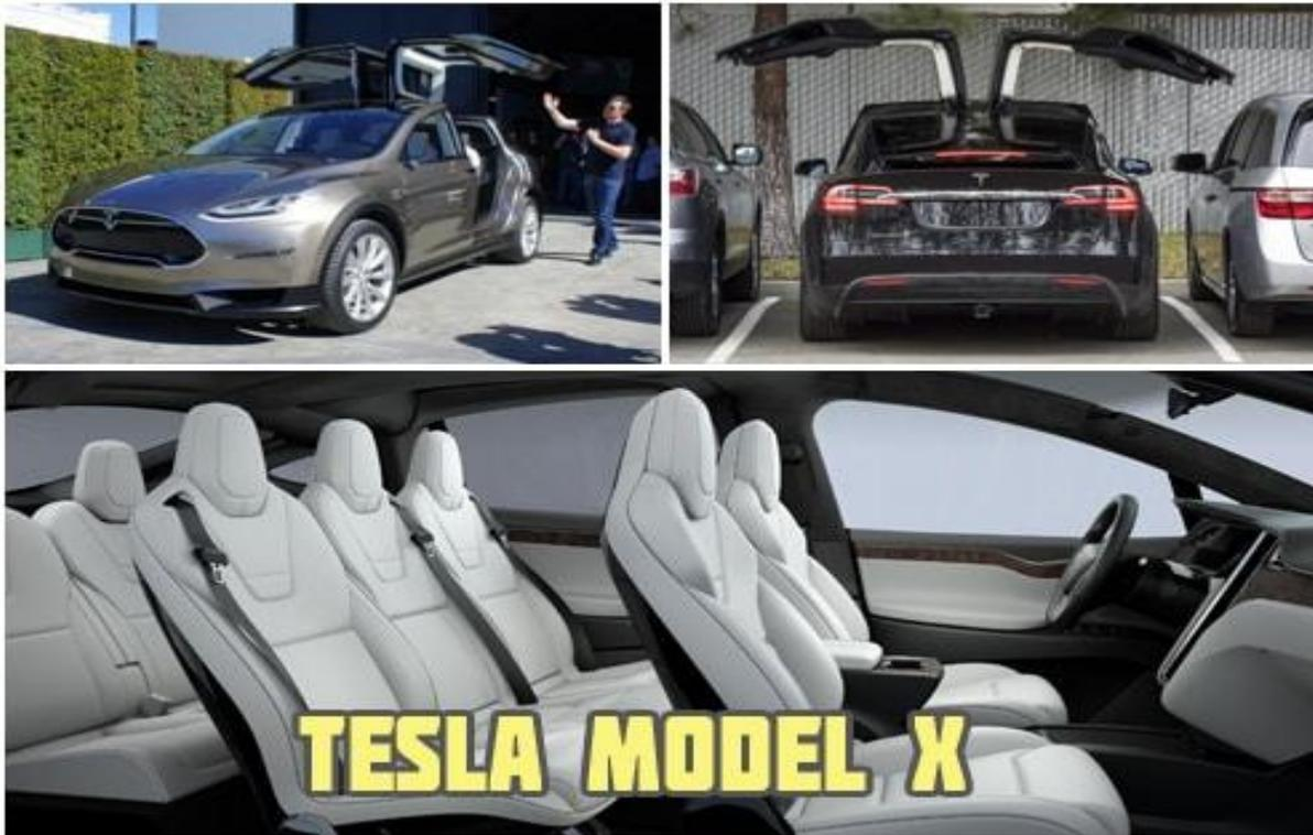
Задние двери электрокара открываются вертикально, производитель назвал подобную реализацию Falcon Wings, что в переводе значит крылья сокола.
