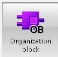
Организационные блоки. Осуществляют связь операционной системы с программой пользователя. Различаются способом запуска. Могут выполняться циклически (основной способ), по времени, по аппаратным прерываниям. В одних ОБ осуществляется вызов программных блоков, другие производят диагностику и выполняют ряд других функций. Могут выполнять роль программных и содержать программу пользователя.
