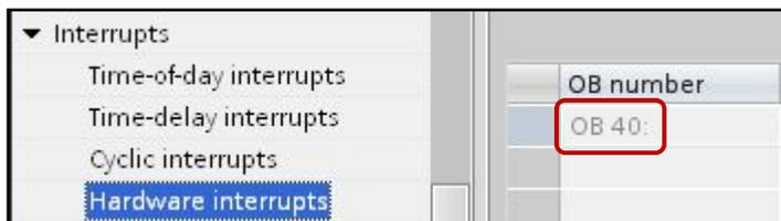
При выходе сигнала за заданные пределы системой будет вызван OB40
