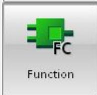
Функции – блоки, которые также являются программными и содержат программу пользователя. К моменту вызова функции все ее входные данные должны быть определены. Такой механизм позволяет использовать функции без выделенных блоков данных.
