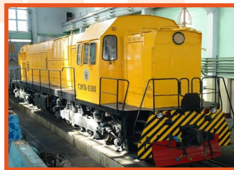
ТЭМ7А 8-осный маневрово - вывозной, тепловоз, 1470 кВт
