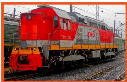
ТЭМ14 8-осный двухдизельный маневрово-вывозной тепловоз, 1764 кВт
