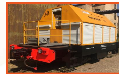
Многопрофильный маневровый тяговый модуль, 150-500 кВт
