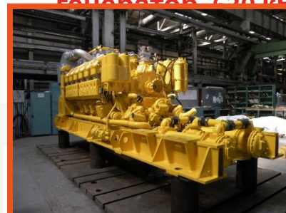
12 ДМ-21 12-цил. двигатель и ДГ ДГ-1400, АДГ-1600, 1400, 1600 кВт
