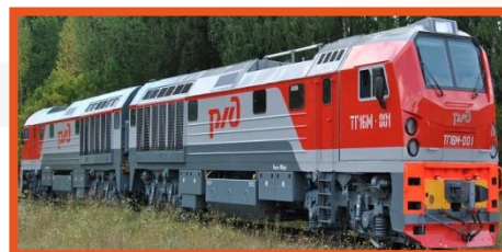
ТГ16М Двухсекционный магистральный тепловоз, 2940 кВт
