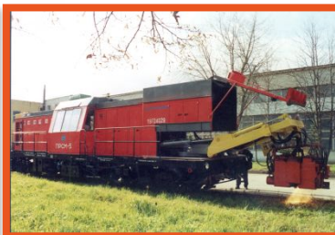
Путевая рельсварочная самоходная машина ПРСМ-5
