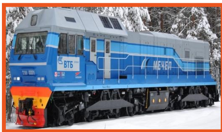
ТЭ8 8-осный тепловоз, магистрального типа, 2460 кВт
