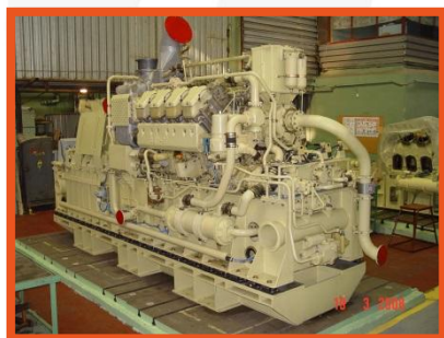
ДГ-880, 882 8-цилиндровый дизельный генератор 880, 882 кВт
