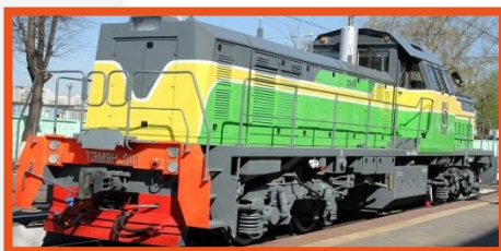
ТЭМ9Н маневровый тепловоз, с гибридным приводом, 882 кВт
