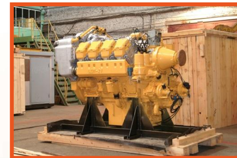
8DM-21 8-цилиндровый дизельный двигатель 882 кВт
