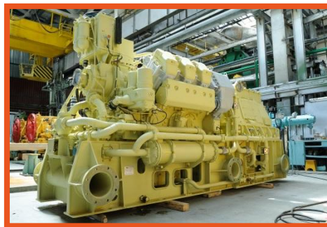
ДГ - 630, АДГ-630 6-цилиндровый дизельный генератор 630 кВт
