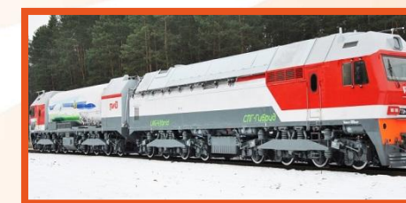
ГТ1h Магистральный газотурбовоз, 8500 кВт
