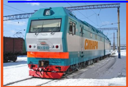
2ЭС6 грузовой двухсекционный электровоз постоянного тока
