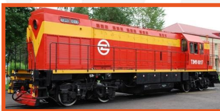
ТЭМ9, ТЭМ9ТА 4-осный маневровый тепловоз, 882 кВт
