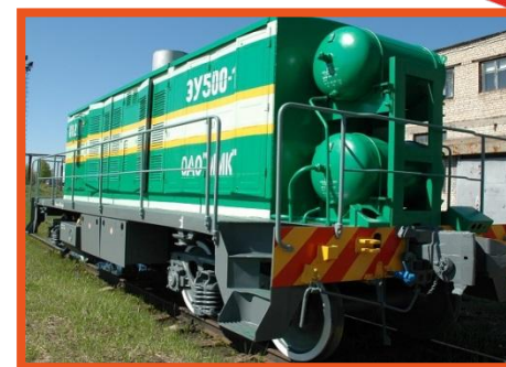
ЭУ500-1 Бустерная энергоустановка, 500 кВт
