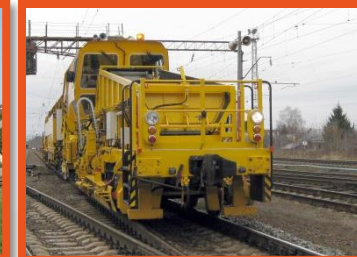
Многофункциональная путевая машина RUMA
