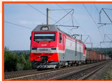
2ЭС7 Электровоз переменного тока с асинхронным приводом
