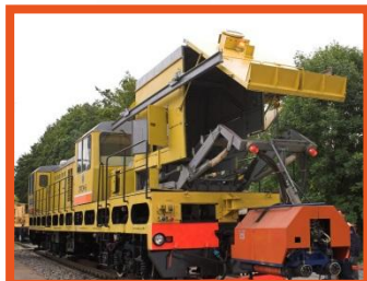
Путевая рельсварочная самоходная машина ПРСМ-6
