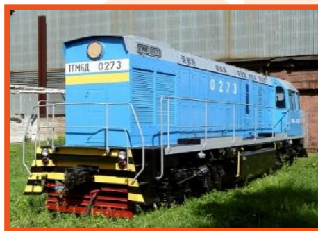
ТГМ6Д 4-осный маневровый тепловоз, 882 кВт
