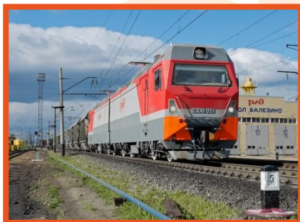
2ЭС10 грузовой двухсекционный электровоз постоянного тока
