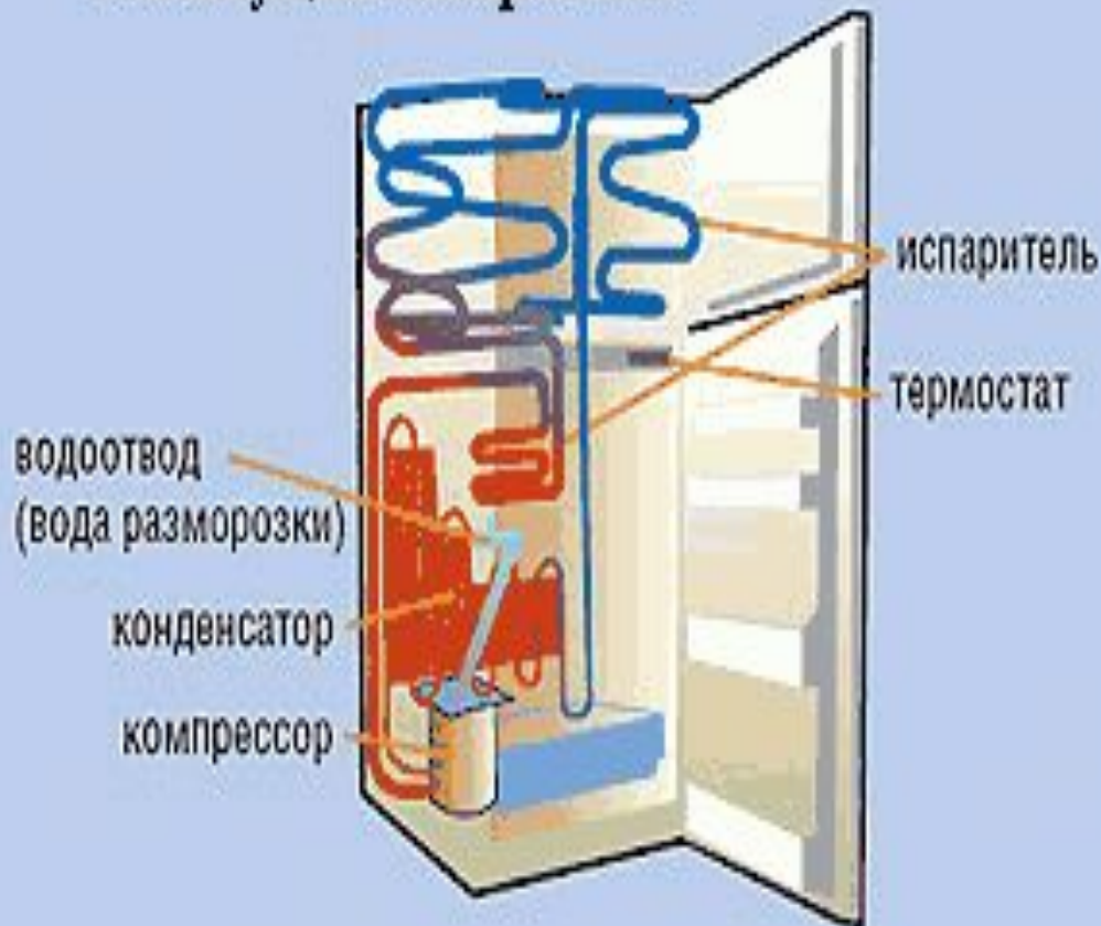
Устройство двухкамерного холодильника с «плачущим» испарителем
