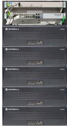
Цифрові репітери MTR3000 в конфігурації Capacity Plus
