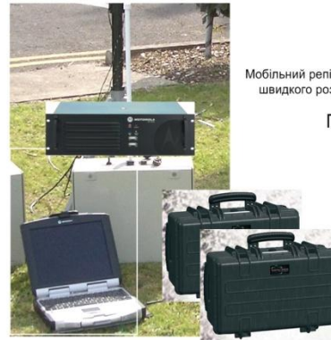
Репітери MTR3000 в конфігурації Link Capacity Plus
