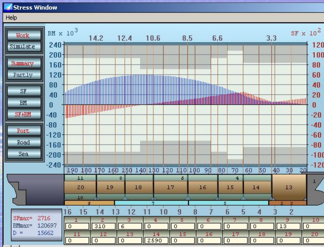
Діаграми перерізуючих сил і перегинаючих моментів
