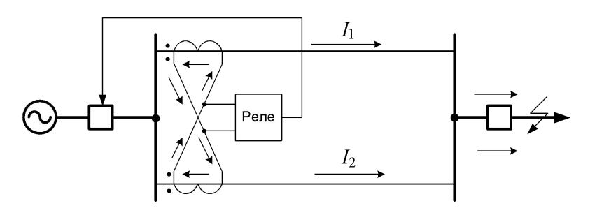
На одноименных фазах каждой линии устанавливаются ТТ с одинаковыми коэффициентами трансформации. Вторичные обмотки ТТ соединяются разноименными зажимами по схеме с циркулирующими токами. Параллельно к соединительным проводам подключается реле.
