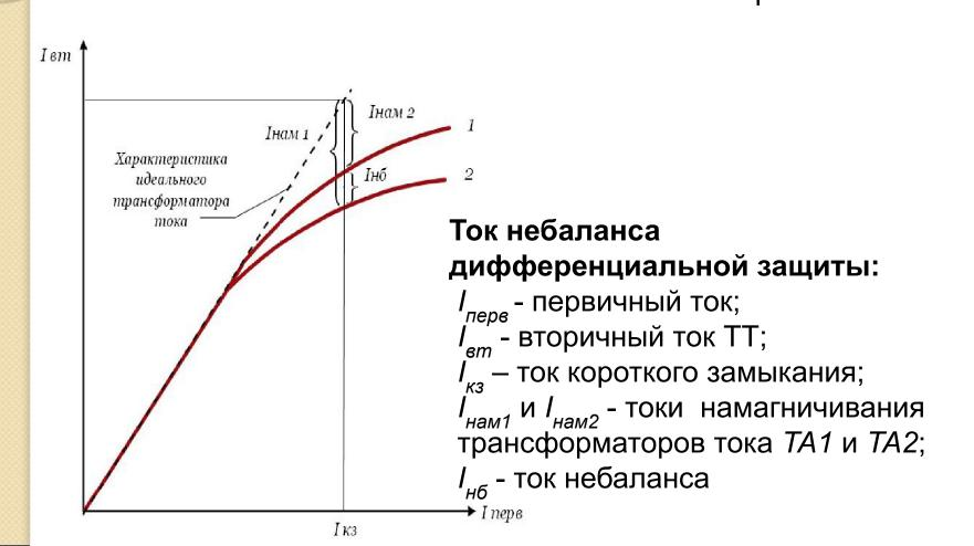
из сопоставления характеристик 7 и 2 следует, что ток небаланса  $I_{_{H\!O}}=I_{_{H\!O\!M}1}-I_{_{H\!O\!M}2}$
