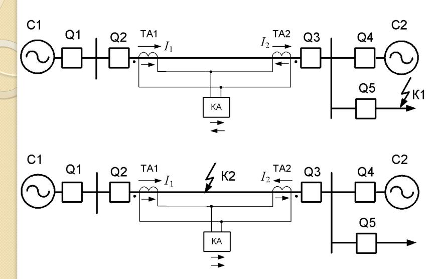
Принцип действия продольной дифференциальной защиты: К1 — внешнее К3; К2 — внутреннее К3
