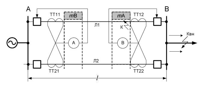
После отключения поврежденной линии с противоположной стороны не работающая до этого защита приходит в действие и отключает поврежденную линию. Например, при КЗ на Л1 в точке вблизи шин п/ст В защита А не работает, т.к.  $I_{\rm p} < I_{\rm c.3}$ . После отключения поврежденной Л1 со стороны п/ст В (где ток  $I_{\rm p}$  достаточен для надежного действия защиты В) весь ток  $I_{\rm K3}$  направится от п/ст А к месту повреждения по Л1.
