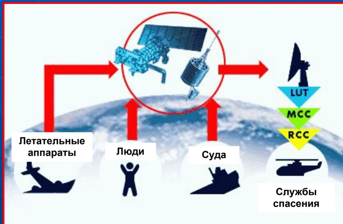
Система КОСПАС- SARSAT включает в себя два типа спутников:
