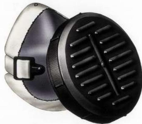
Респиратор многоразового использования со сменным фильтром. Защищает от силикатной, металлургической, горнорудной, угольной, табачной пыли, пыли порошкообразных удобрений и интоксидов, не выделяющих токсических газов. Широко применяется шахтёрами при высокой запылённости (500 мг/м<sup>3</sup> и более). Масса — 250 г.
