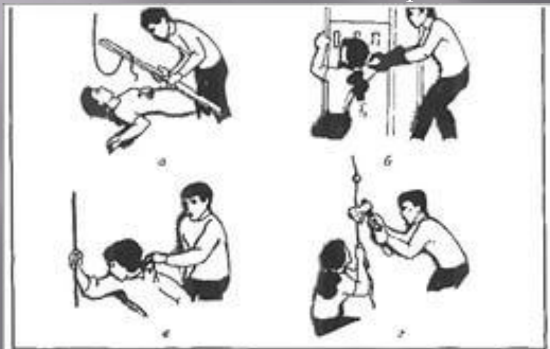
Рис. 83. Освобождение пострадавшего от действия электрического тока: а – освобождение пострадавшего отбрасыванием провода доской; б – оттащивание
