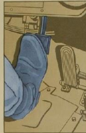
При нажатии на педаль привода рабочей тормозной системы торможение (ощущение упругости педали) должно начинаться в начале второй половины хода педали. При этом не должен загораться лампа аварийного останова рабочей тормозной системы.
