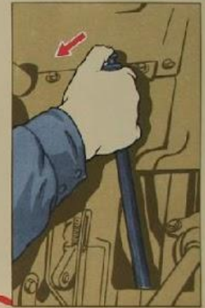
При нажатии на рычаг стояночной тормозной системы усилием 50-60 даН (50-60 кгс) рычажок должен переместиться по сектору на 9-10 зубьев (щелчков). При этом контрольная лампа должна загореться со второго щелчка.
