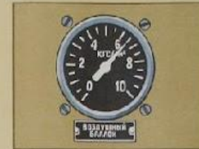
Давление воздуха в воздушном баллоне должно быть не ниже 620 кПа (6,2 кгс/см 2 ).
