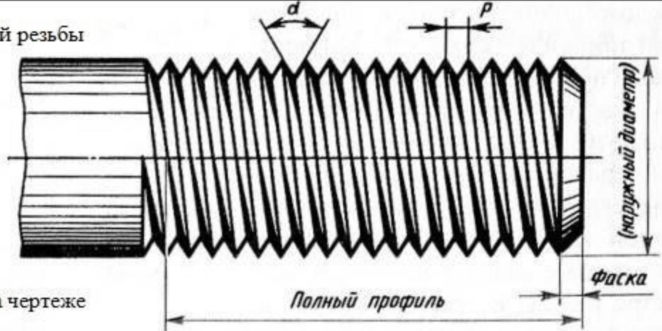
Обозначение резьбы на чертеже
