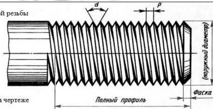
Обозначение резьбы на чертеже
