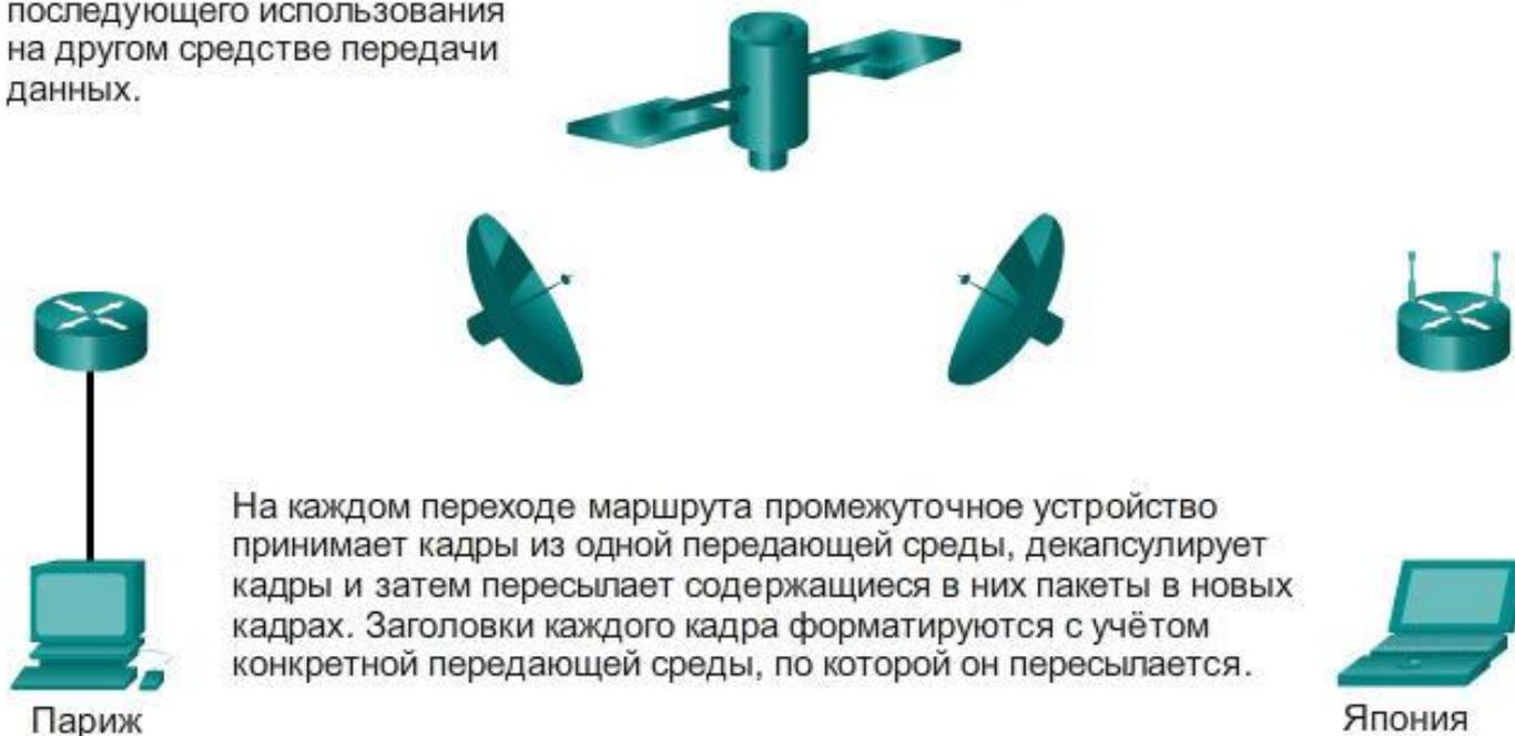
На каждом переходе маршрута промежуточное устройство принимает кадры из одной передающей среды, декапсулирует кадры и затем пересылает содержащиеся в них пакеты в новых кадрах. Заголовки каждого кадра формируются с учётом конкретной передающей среды, по которой он пересылается.
