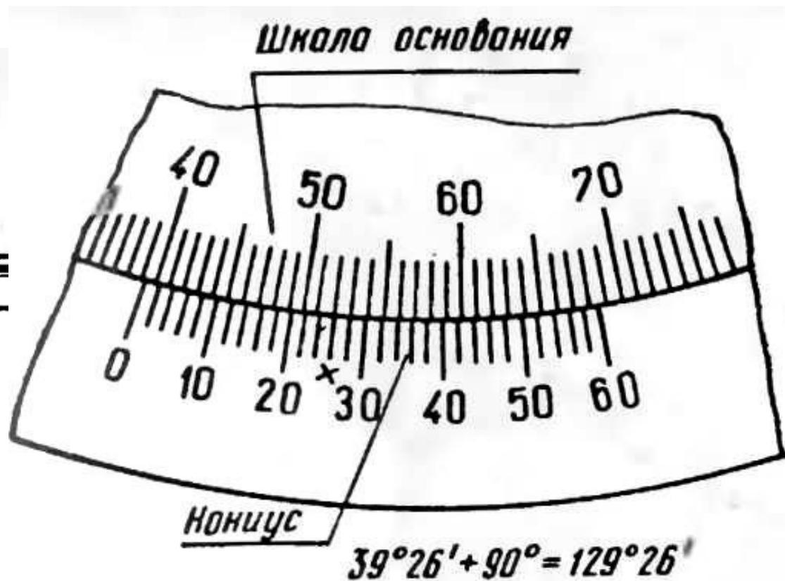
Рис.9. Измерение тупых углов
