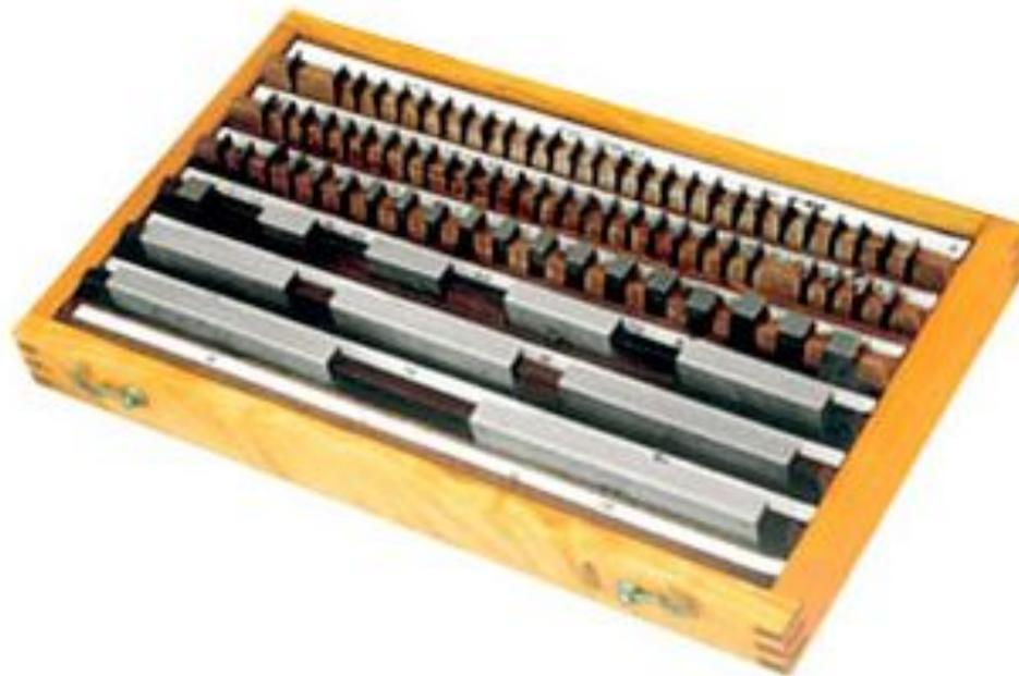
Концевые меры длины плоскопараллельные
