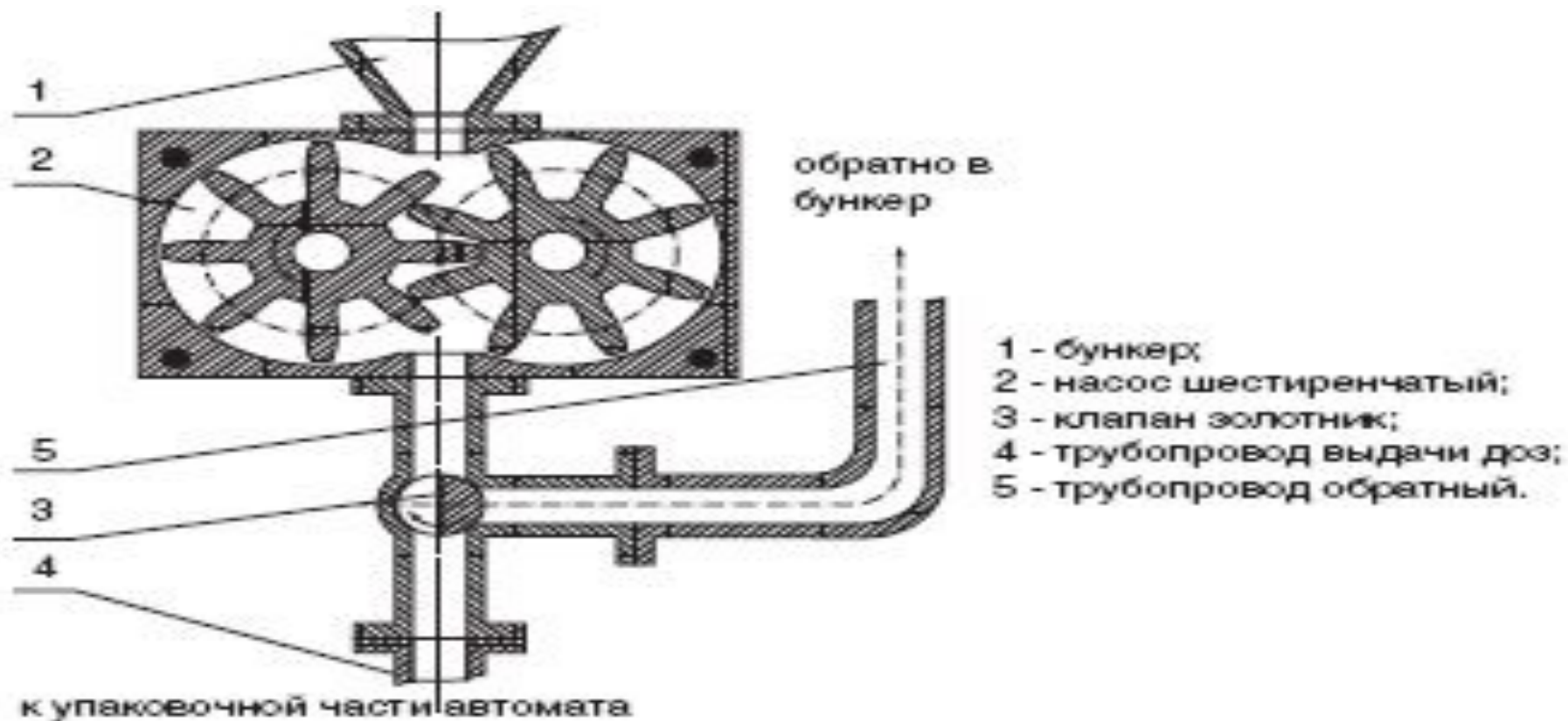
Рисунок 6. Схема объемного шестеренчатого дозатора.
