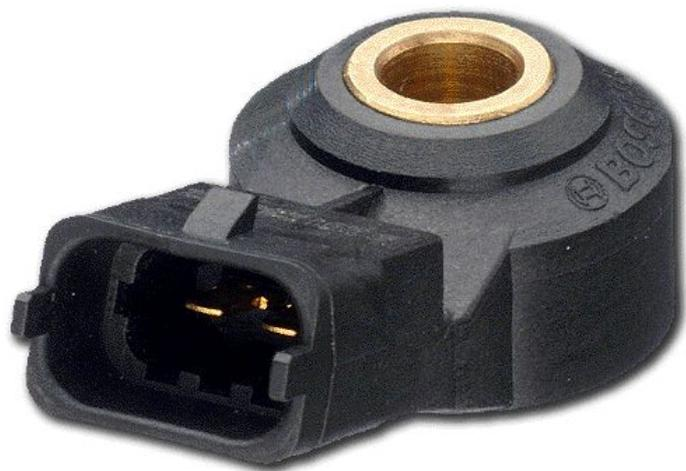
Датчик детонации регистрирует все колебания корпуса двигателя, возникающие при его работе. Сотрясения корпуса деформируют пьезокристаллический элемент, установленный в корпусе датчика, который выработывает электрический сигнал, посылаемый в устройство управления.
