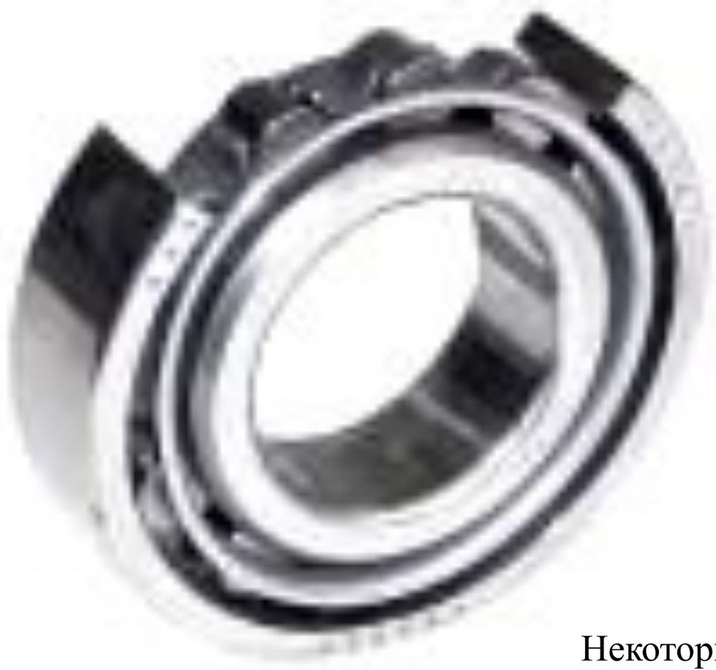
Некоторые цилиндрические роликоподшипники не имеют фланцев на наружном и внутреннем кольце, таким образом, могут иметь осевые смещения относительно друг друга. Могут применяться в качестве подшипника, крепящего свободный конец вала.
