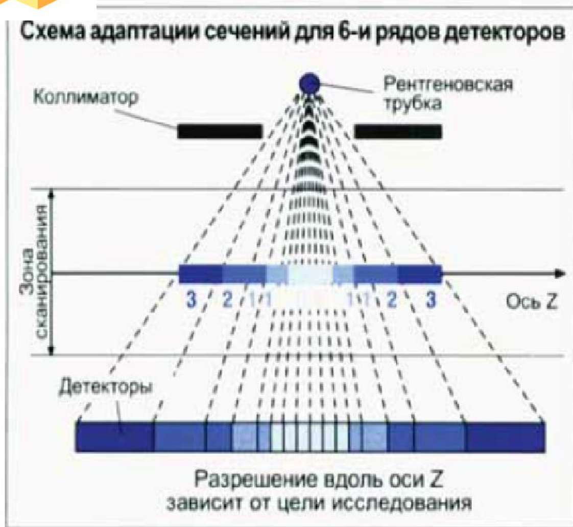
Рис. 10.2. Схема сканирования для шестирядного томографа (используется на Siemens Emotion 6)
