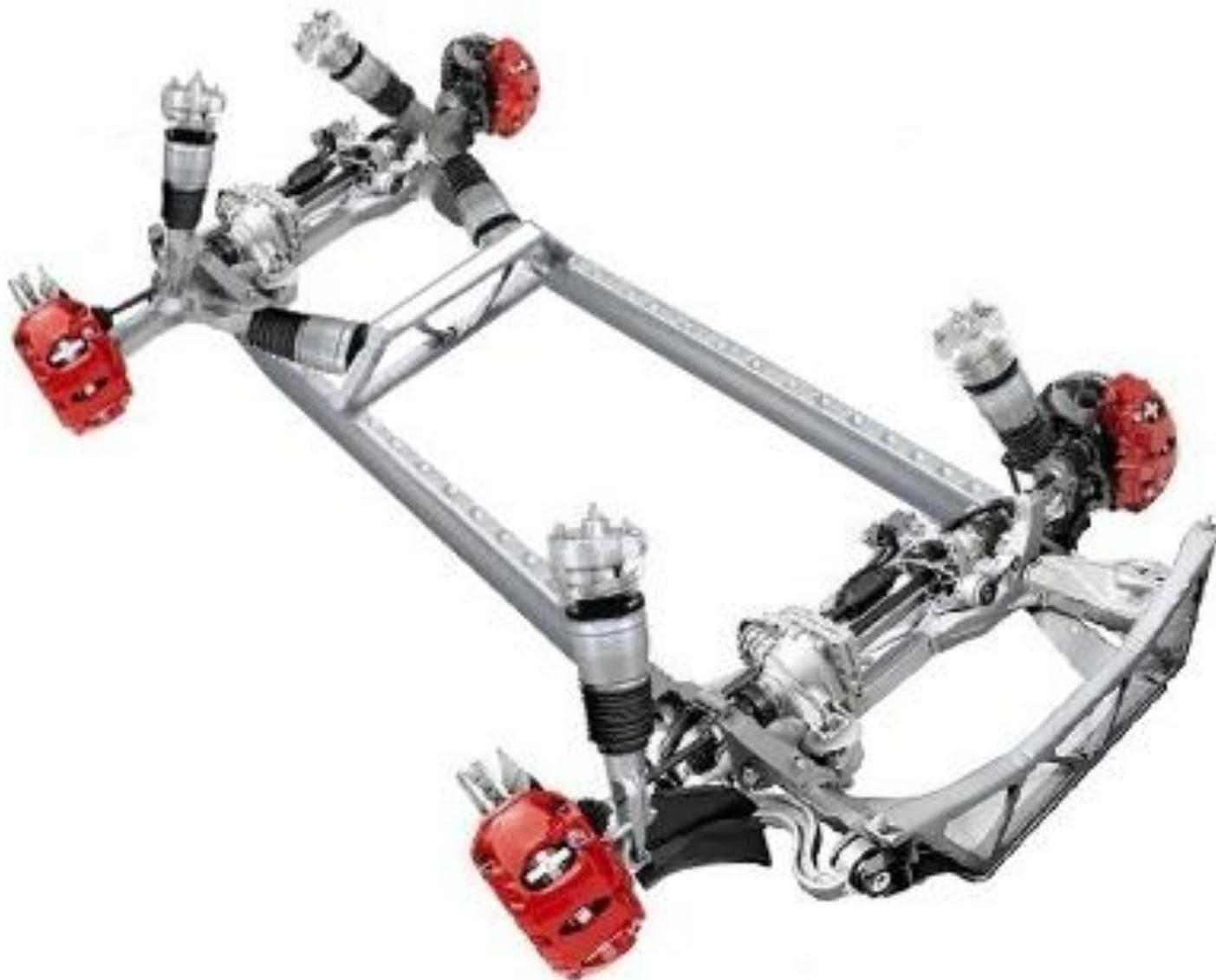
**Регулируемые подвески автомобиля.** Кузов автомобиля с обычной подвеской опускается по мере загрузки автомобиля. При этом упругие элементы подвески сжимаются и работают в таком состоянии, что снижает плавность хода. Кроме того изменяется положение фар и может нарушиться управляемость автомобиля.
