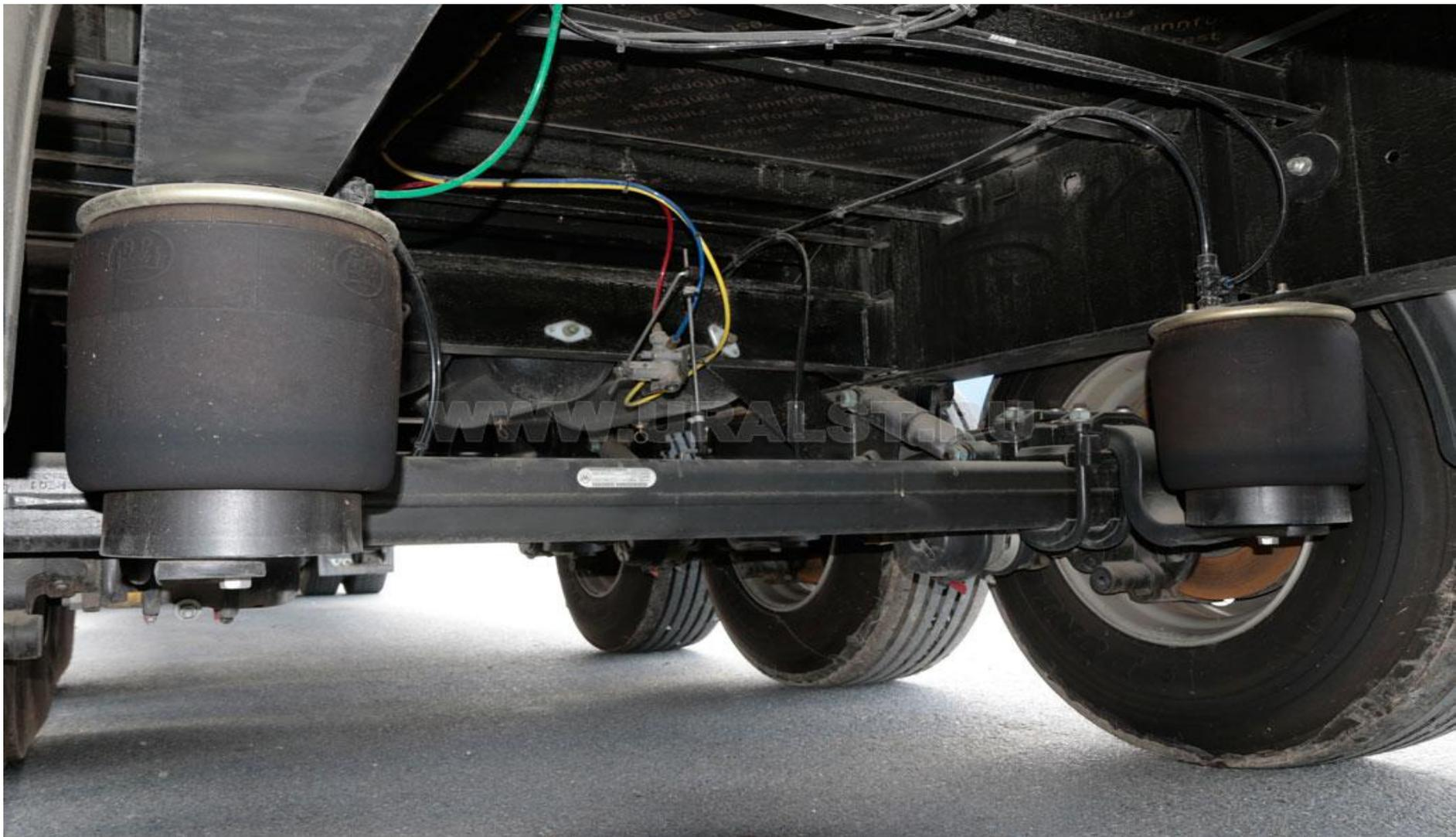
Пневматическая подвеска автобусов обеспечивает постоянство уровня пола вне зависимости от количества пассажиров, что увеличивает комфорт и безопасность при их посадке и высадке. Конструкция пневматических подвесок некоторых автобусов дает возможность дополнительно понижать уровень пола на остановках.
