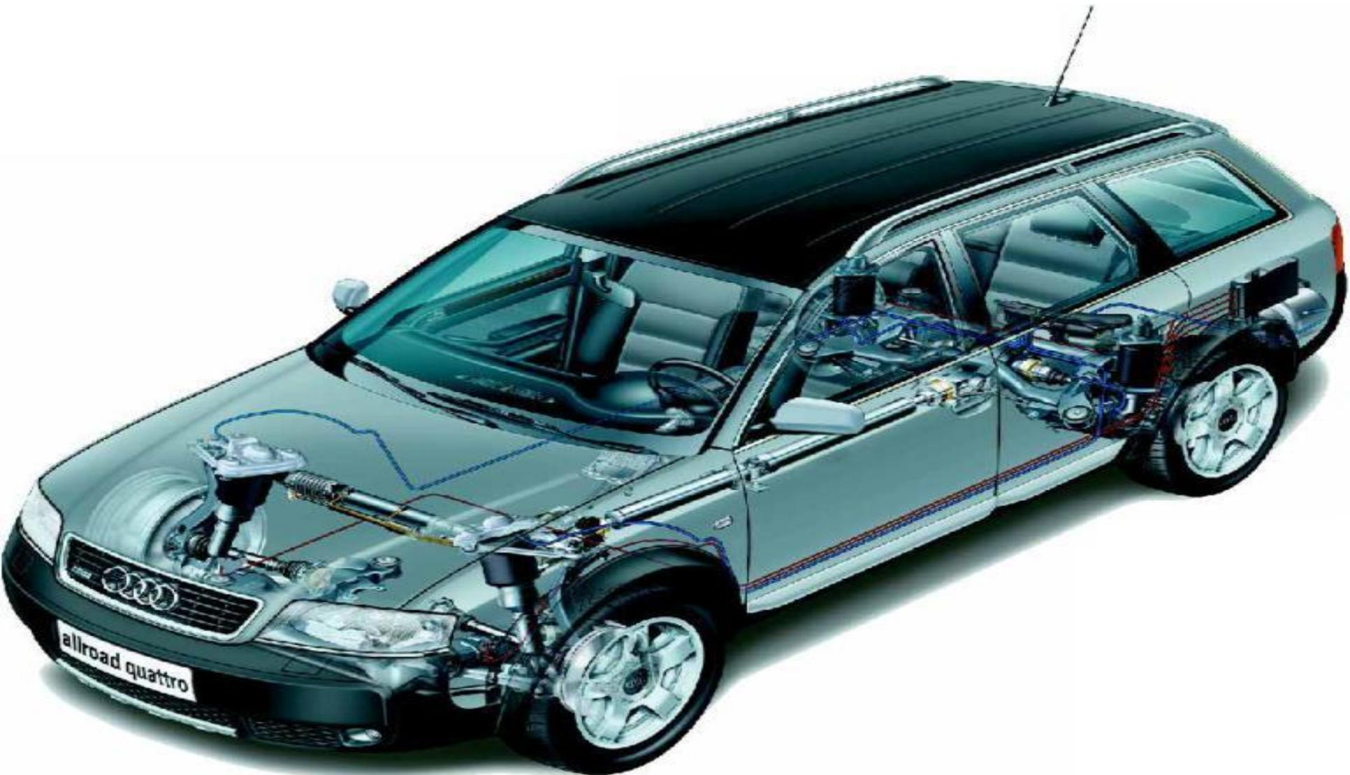
**Регулируемые подвески автомобиля.** Системы выравнивания кузова применяют двух видов. Они могут срабатывать сравнительно медленно, особенно для регулировки статического положения в зависимости от нагрузки, или достаточно быстро для реагирования на переходные процессы во время движения.
