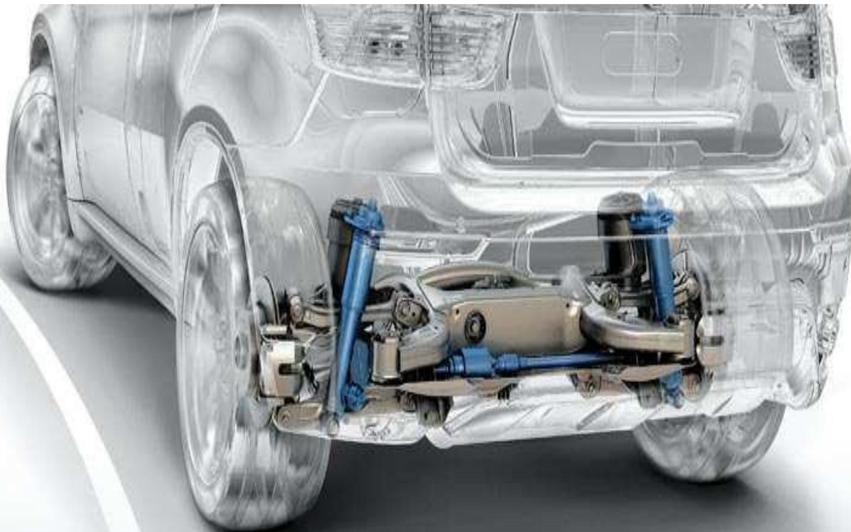
Существующие на сегодняшний день экспериментальные системы обеспечивают постоянную оценку нагрузки, приходящейся на каждое колесо, и при ее увеличении (например, когда колесо наезжает на препятствие) гидравлический цилиндр приподнимает колесо, а при уменьшении нагрузки опускает.
