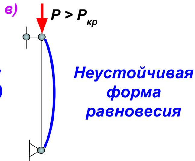
Неустойчивая форма равновесия связана с неограниченным ростом деформаций и напряжений, поэтому при превышении сжимающей силой ее критического значения конструкция разрушается.
