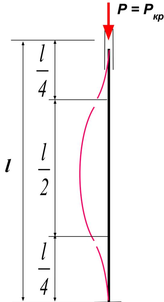
При потере устойчивости средняя часть стержня длиной  $l$  изогнется по синусоиде, как и стержень длиной  $L=l/2$ , с шарнирно закрепленными концами.
