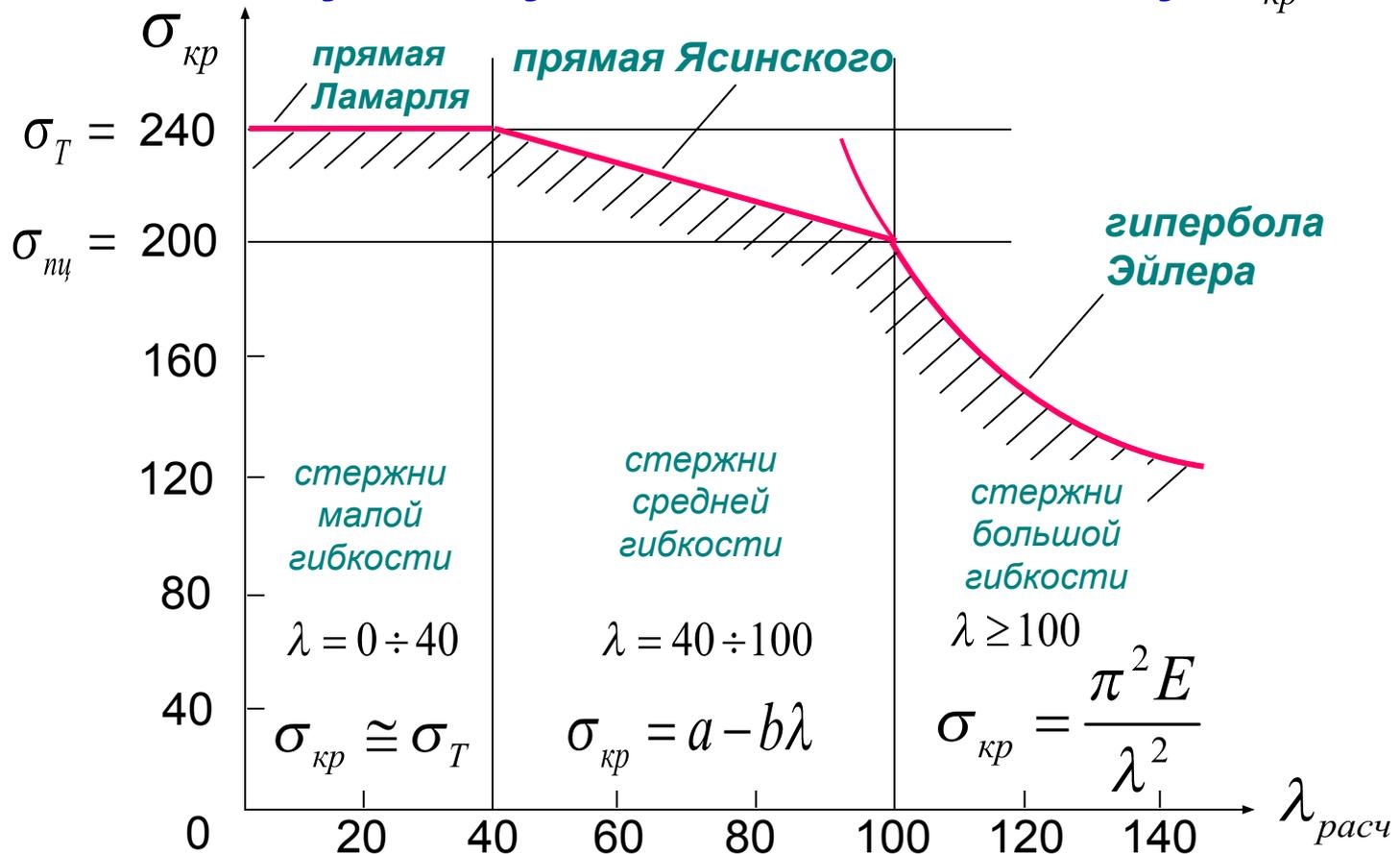
*Стержни малой гибкости рассчитывают на прочность.*
