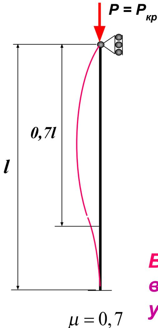
При потере устойчивости верхняя часть стержня на длине  $0,7l$  изогнется на полуволну синусоиды.
