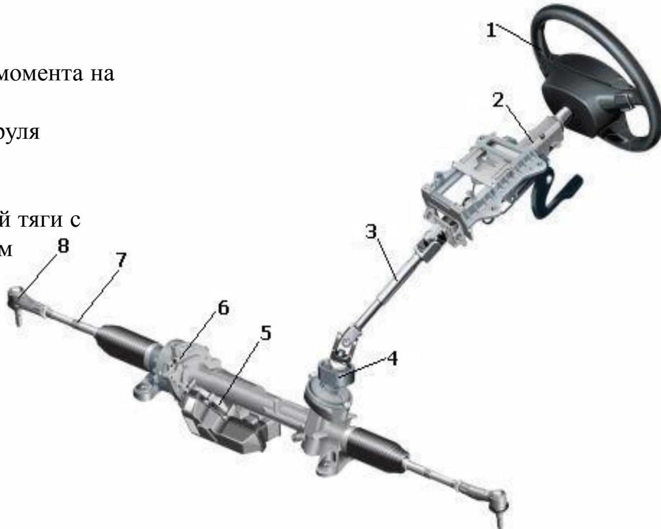
**Рулевое колесо** воспринимает от водителя усилия, необходимые для изменения направления движения, и передает их через рулевую колонку рулевому механизму. Диаметр рулевого колеса легковых автомобилей находится в пределах 380 - 425 мм, грузовых автомобилей – 440 – 550 мм. Рулевое колесо спортивных автомобилей имеет меньший диаметр.
