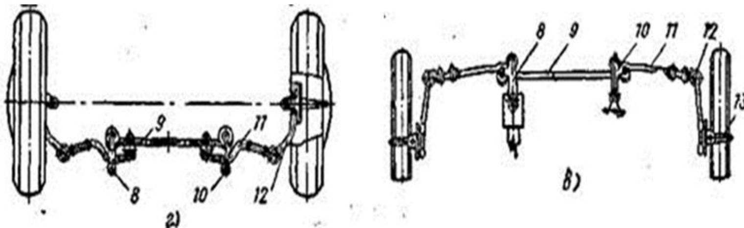
Маятниковый рычаг 10 установлен шарнирно на оси в кронштейне, закрепленном на раме основания кузова. Концы сошки 8 и маятникового рычага 10 или средней тяги соединены шарнирно двумя промежуточными боковыми тягами 11 с рычагами 12 поворотных кулаков 13 или поворотных стоек колес.
