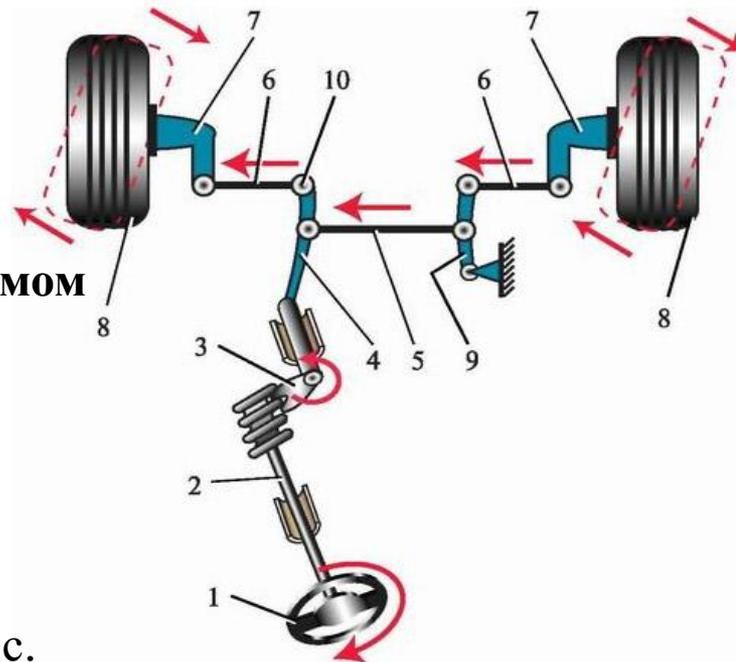
Схема рулевого управления с механизмом типа "червяк-ролик":
