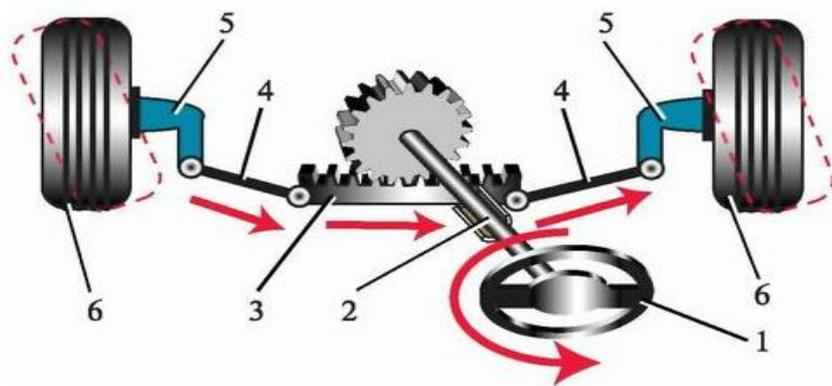
**Схема рулевого** -рейка": 1 – рулевое колесо; 2 – вал с приводной шестерней; 3 – рейка рулевого механизма; 4 – правая и левая рулевые тяги; 5 – поворотные рычаги; 6 – передние колеса автомобиля
