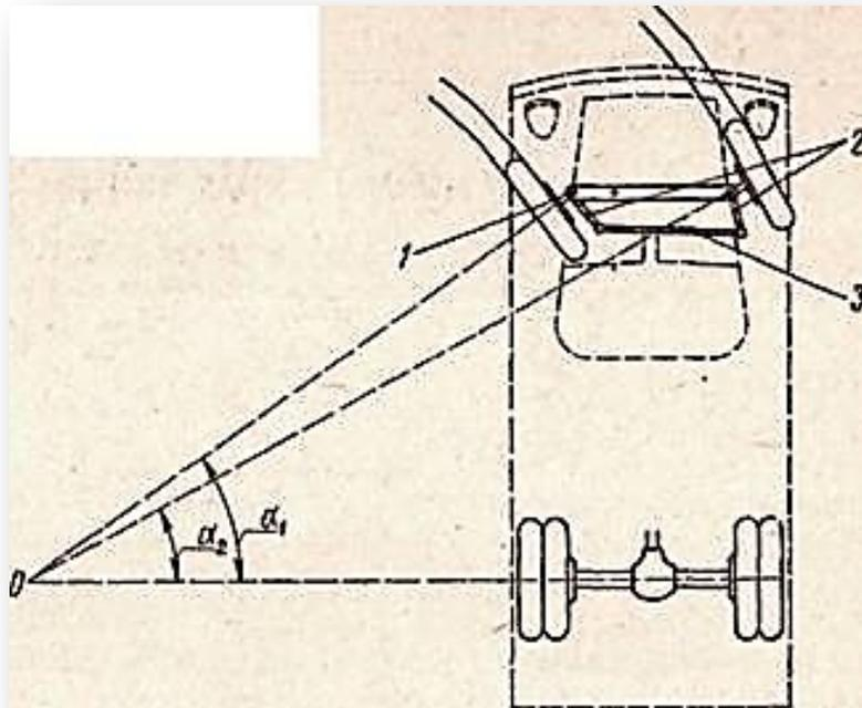
В центре поворота должны пересекаться продолжения осей всех колес автомобиля. Для соблюдения этого управляемые колеса должны поворачиваться на различные углы: внутреннее колесо на больший угол, а внешнее — на меньший. Такой поворот колес обеспечивает рулевая трапеция.
