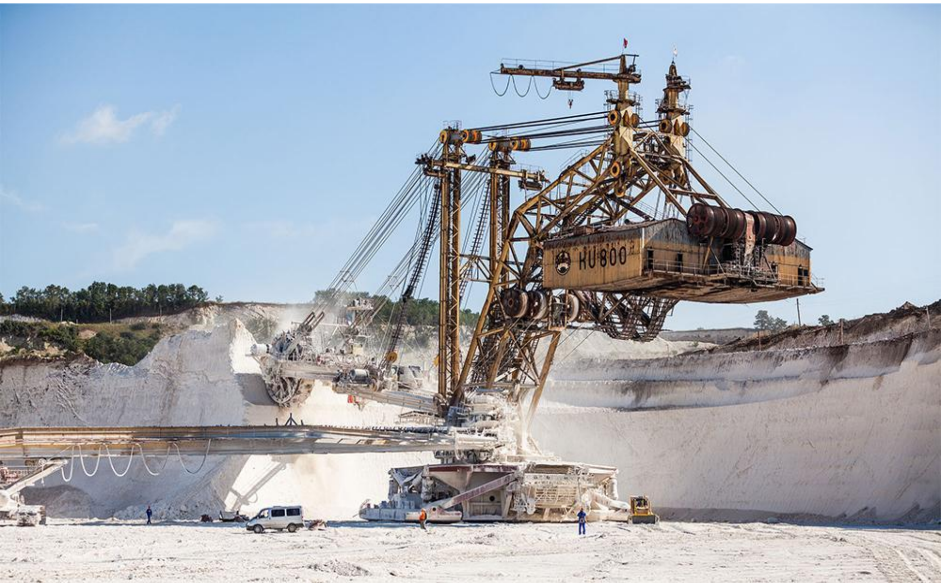
Экскаватор роторного типа / www.mining-portal.ru/ .
