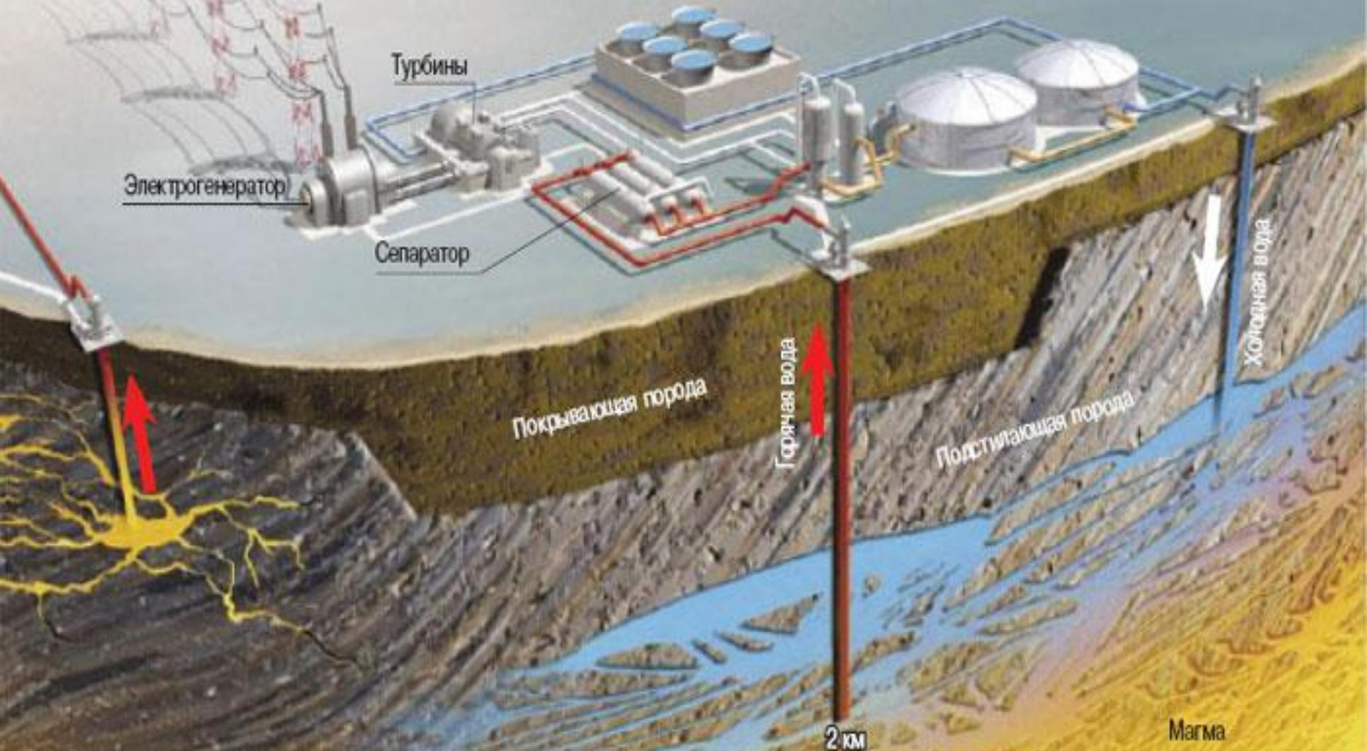
При температуре воды выше 150 °С используется прямой производственный цикл, при более низкой температуре – бинарный
