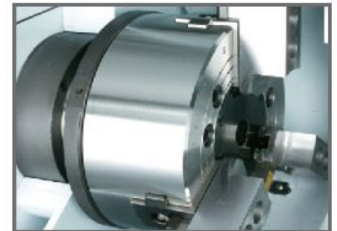
Механизированный зажимной патрон шпинделя передней бабки
