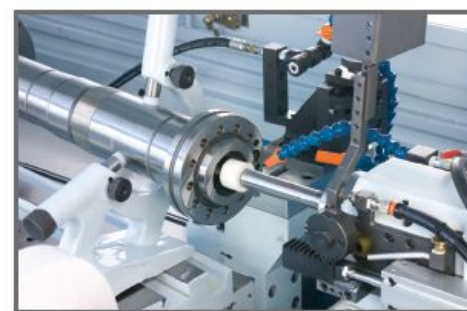
Рабочая зона комбинированного двухшпindelного станка
