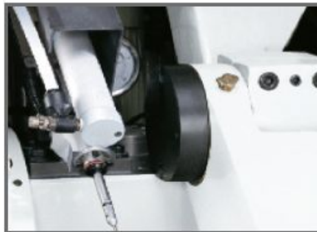
Контактный датчик для привязки к детали
