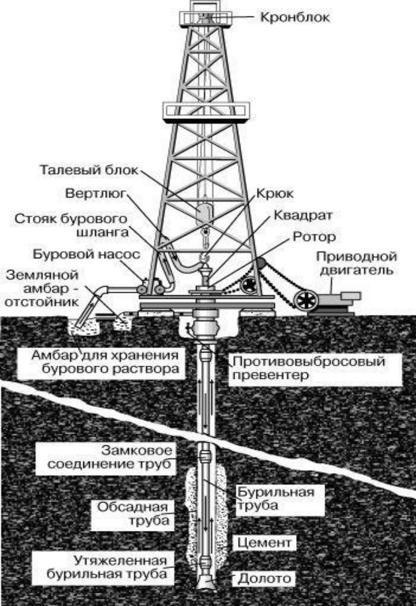
Рис.4 Схема бурения скважины
