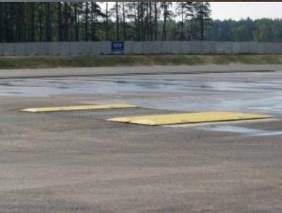
Плита динамического заноса, придавать дозированное боковое ускорение задней оси автомобиля, провоцируя ее занос
