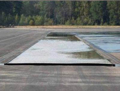
Специальная «ванна» протяженностью 60 метров для отработки действий водителя при возникновении аквапланирования
