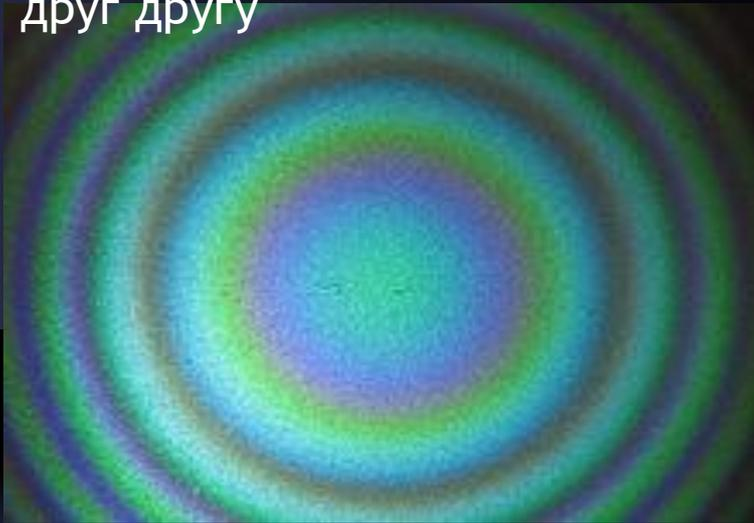
Интерференция, полученная при помощи интерферометра со строго перпендикулярными зеркалами
