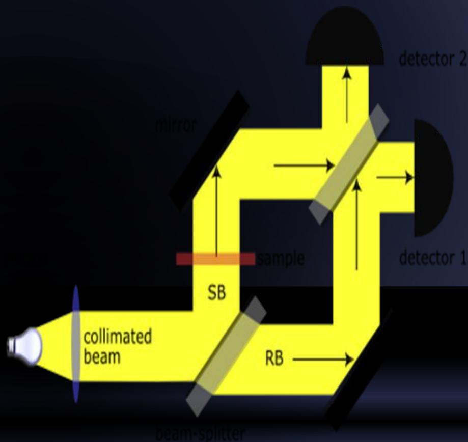
Схема интерферометра Маха —
