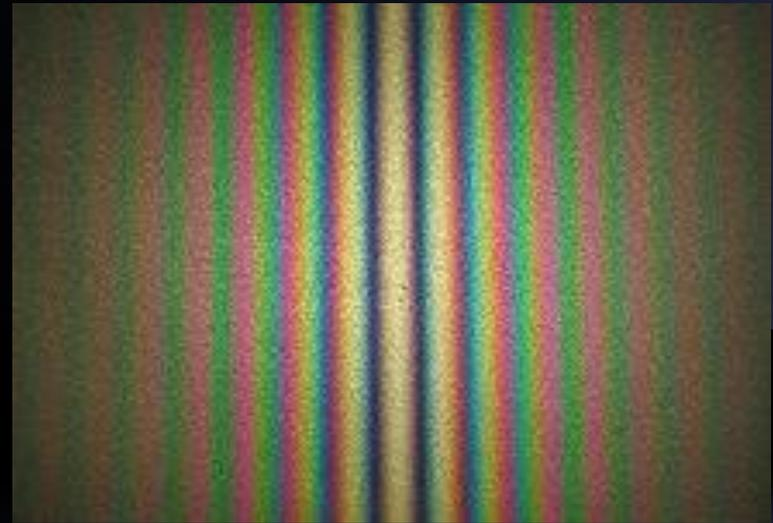
Интерференционная картина, полученная при помощи интерферометра с зеркалами под углом около  $90^\circ$
