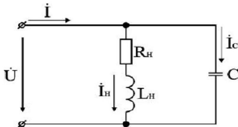
Рис. 1.29 Схема электрической цепи для повышения  $\cos \varphi$
