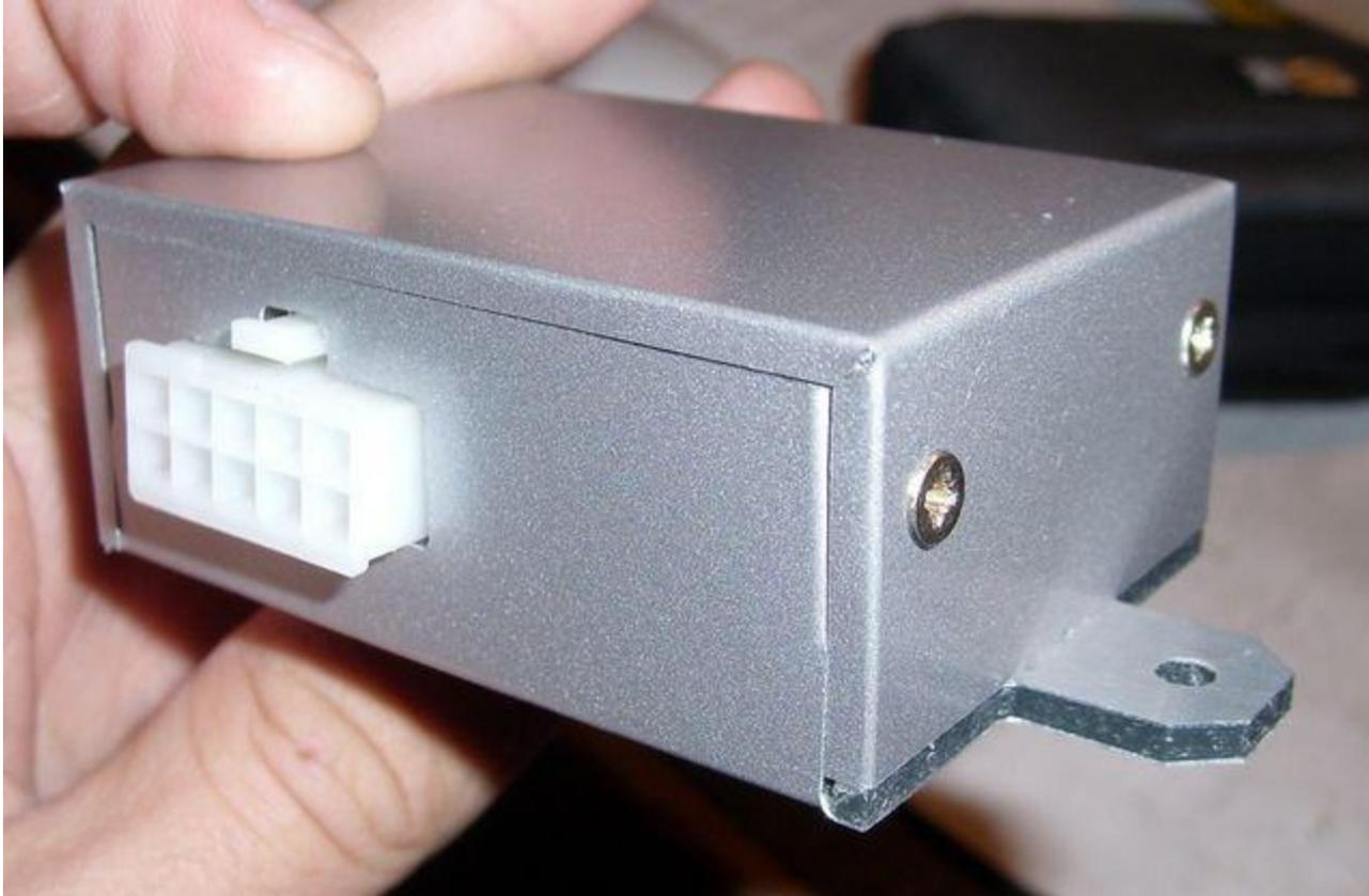
корпус из композита (3мм толщина материала, 2х0.3мм алюминий по краям, внутри пластик, снаружи PVDF краска)
