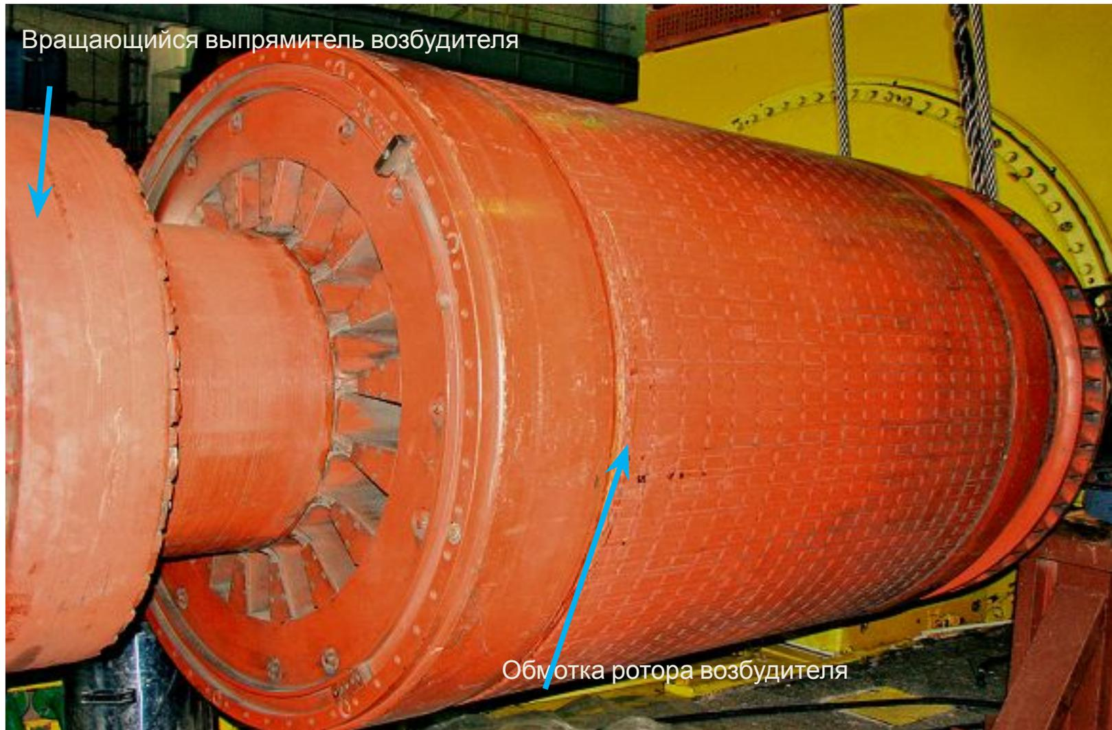
Рис. 7.11. Фото элементов оборудования возбудителя БВД-4600-1500УЗ в разобранном виде
