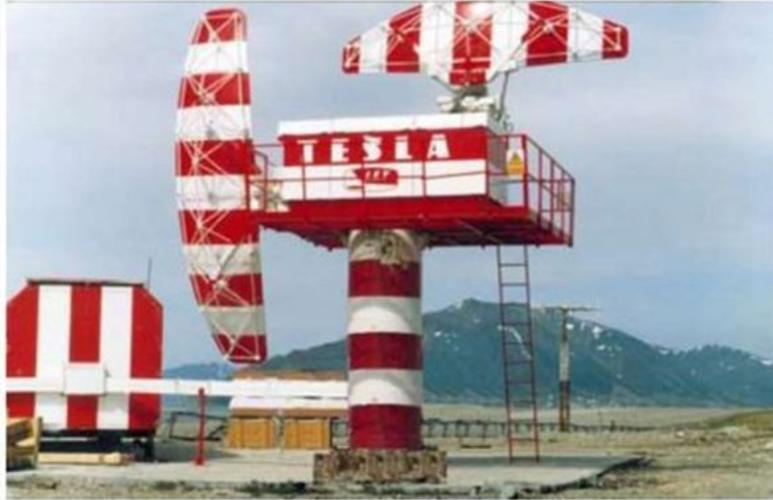
ПРЛС фактически состоит из двух отдельных радиолокационных станций: **курсовой и глиссадной** со своими антенными системами, согласованное качание которых обеспечивается антенным механизмом. **Для получения высоких угловых разрешающих способностей курсовая антенна имеет узкую ДН в горизонтальной плоскости, а глиссадная - в вертикальной.**
