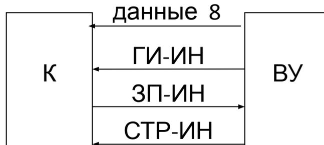
Описываемый интерфейс содержит 3 синхросигнала:
