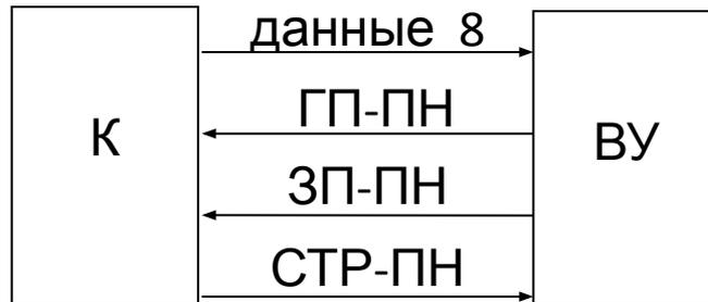
ГП-ПН – сигнал готовности приемника от приемника, указывает на включенное и исправное состояние ВУ. Активный – низкий уровень. ЗП-ПН – запрос приемника. СТР-ПН – строб приемнику.
