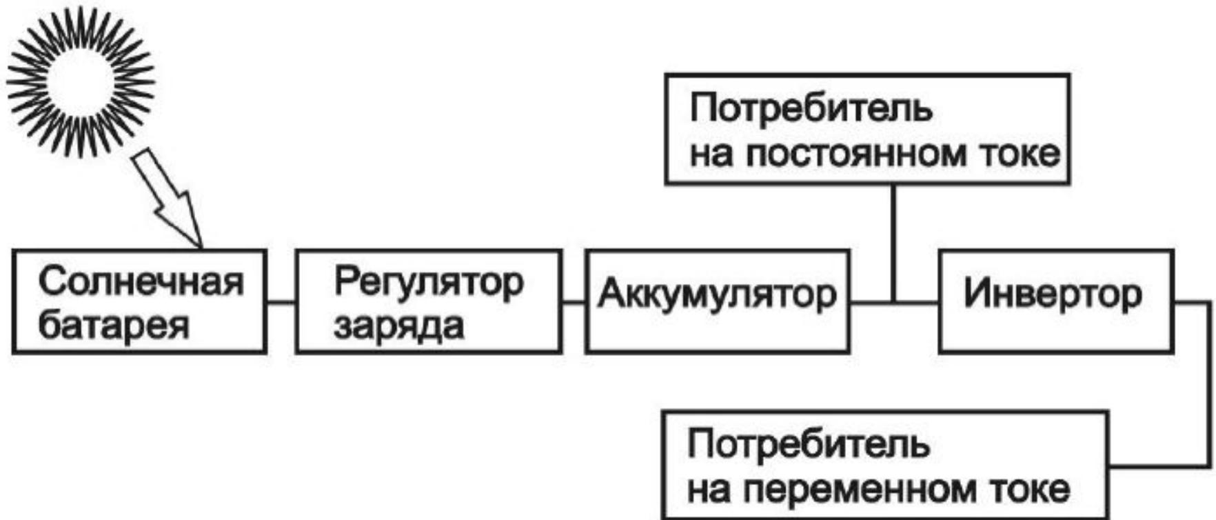
Рис. Принципиальная схема автономной фотовольтаик- установки
