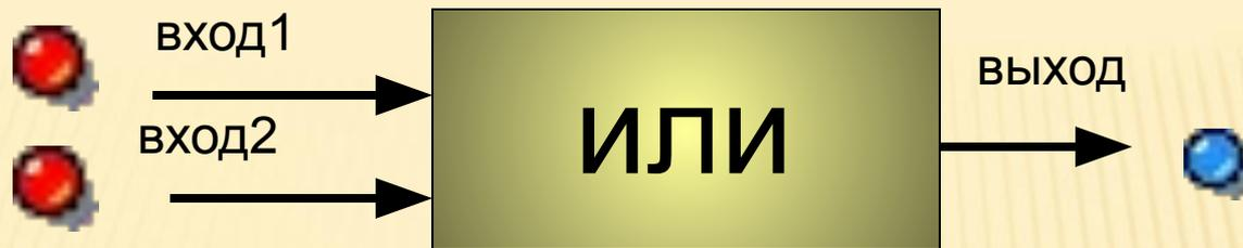
Работа элемента **«ИЛИ»** заключается в том, что на выходе получается сигнал равный «1», когда хотя бы на один из входов был подан единичный сигнал. Элемент имеет два входа и один выход.
