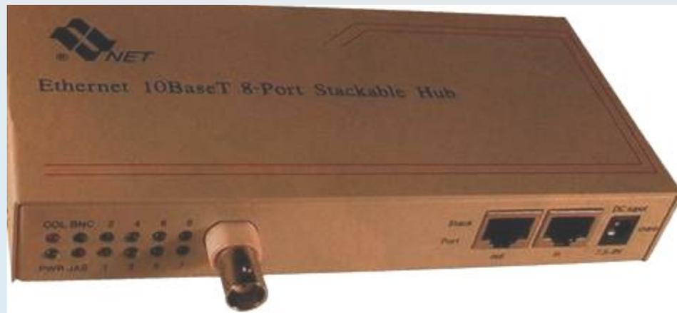
Все порты концентратора равноправны. Получив сигнал от одной из подключенных к нему станций, концентратор транслирует его на все свои активные порты.
