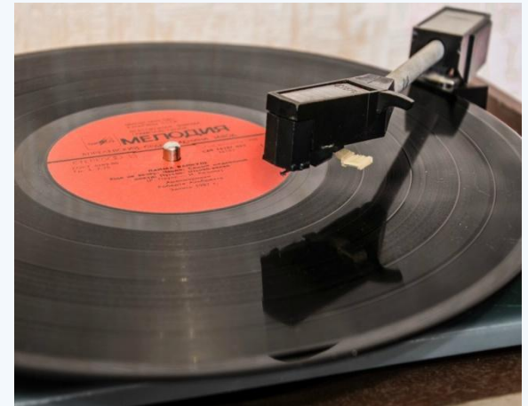
Звуковая дорожка на грампластинке
