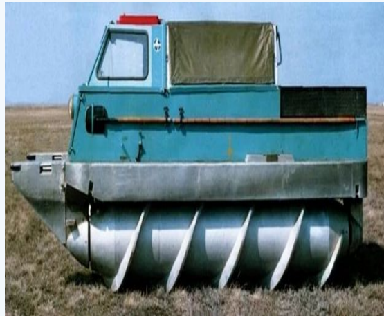
Использование шнека для передвижения
