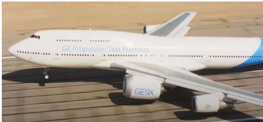
Летающая лаборатория на базе самолета Боинг 747 для испытаний ТРДД GE9X для самолета В.777Х
