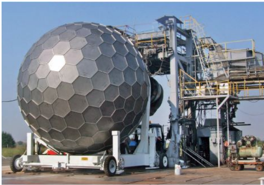
Рисунок 13. Подготовка ПД-14 к проведению исследований акустических характеристик.
