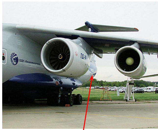
Рисунок 15. Испытываемый опытный ТРДД ПД-14 на ЛЛ ИЛ-76
