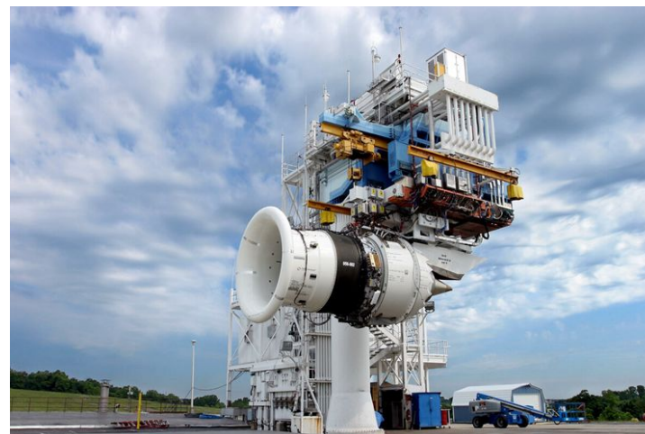
Двигатель GEnX на открытом наземном испытательном стенде General Electric в Пиблз, штат Огайо (США)
