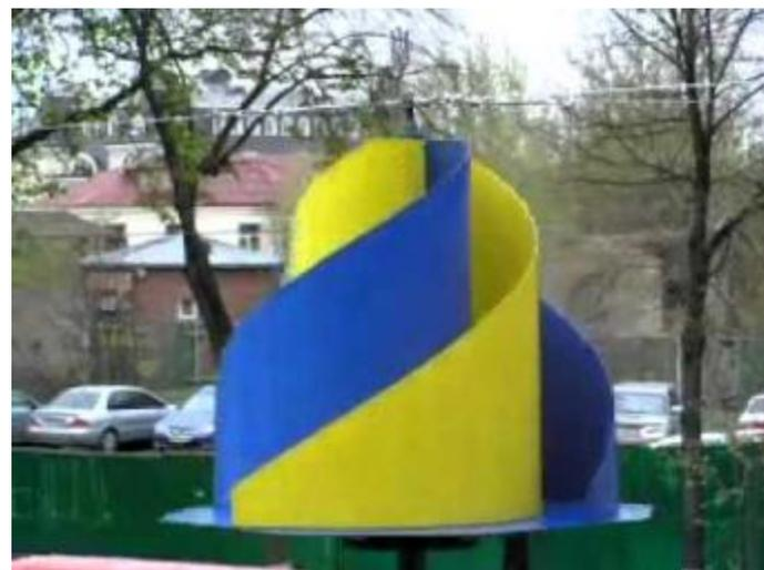
Ко второму классу относятся системы ветродвигателей с вертикальной осью вращения ветрового колеса. По конструктивной схеме они разбиваются на группы:
