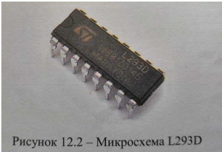
Рисунок 12.2 – Микросхема L293D
