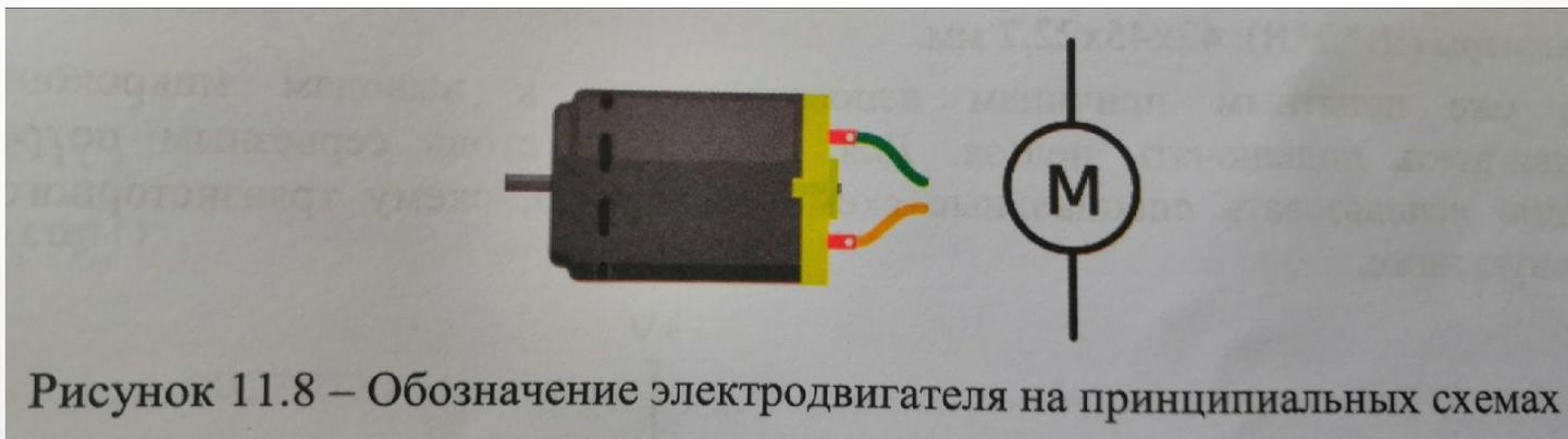
Рисунок 11.8 – Обозначение электродвигателя на принципиальных схемах
