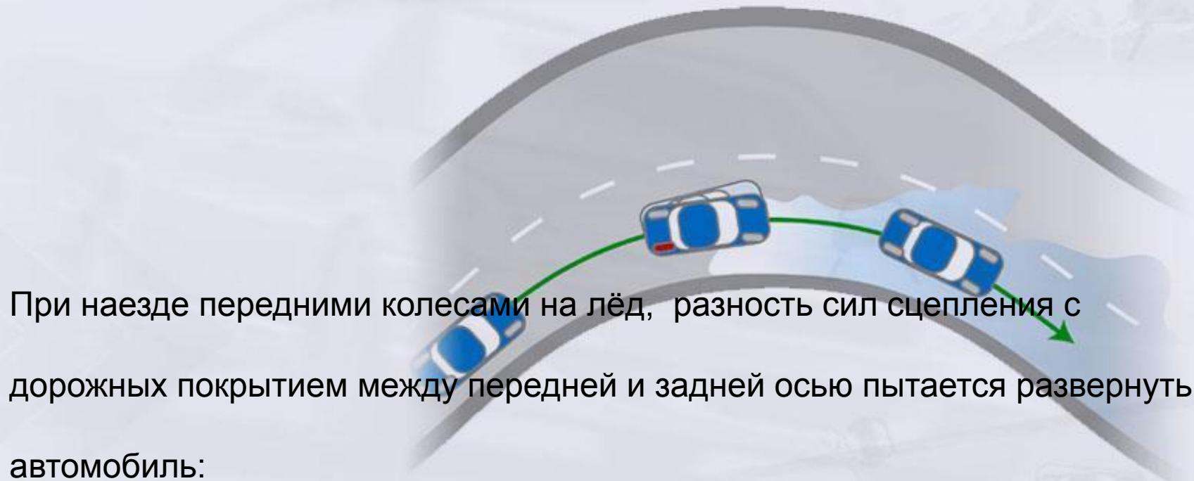
При наезде передними колесами на лёд, разность сил сцепления с дорожным покрытием между передней и задней осью пытается развернуть автомобиль:
