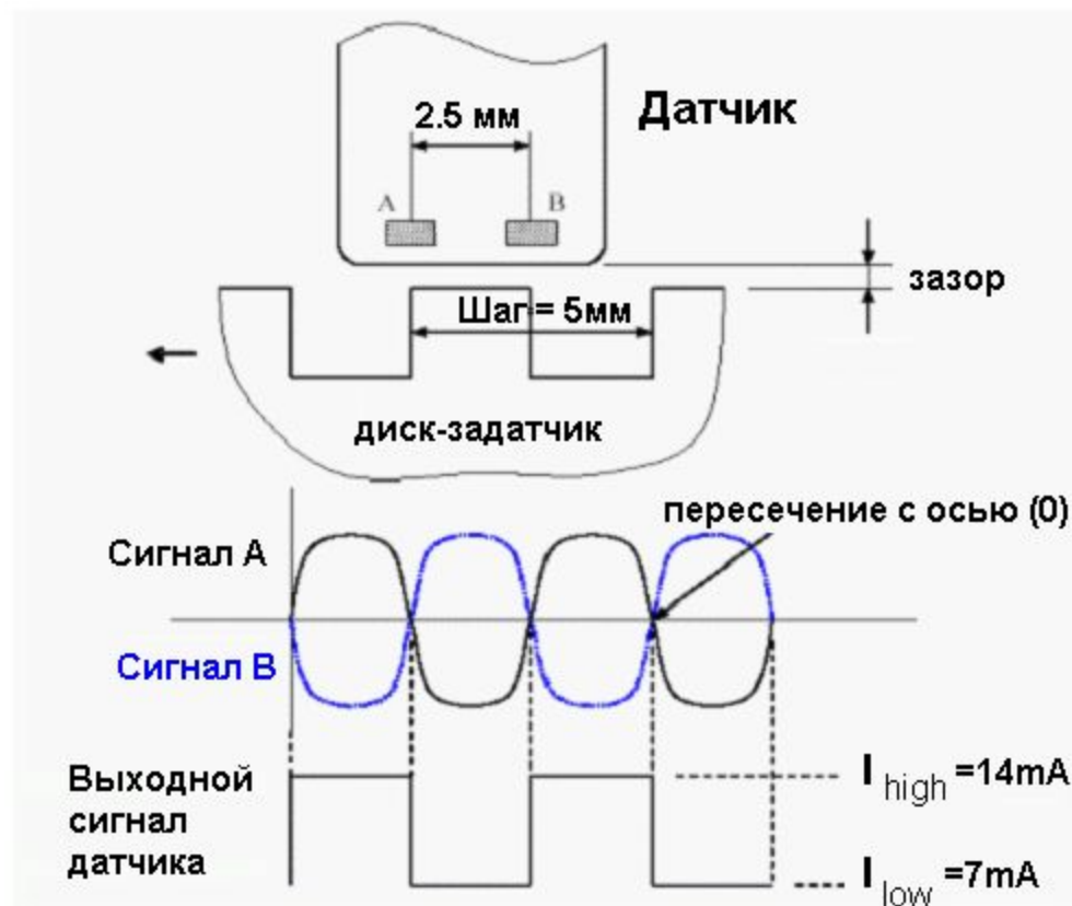
Принцип работы датчика скорости
