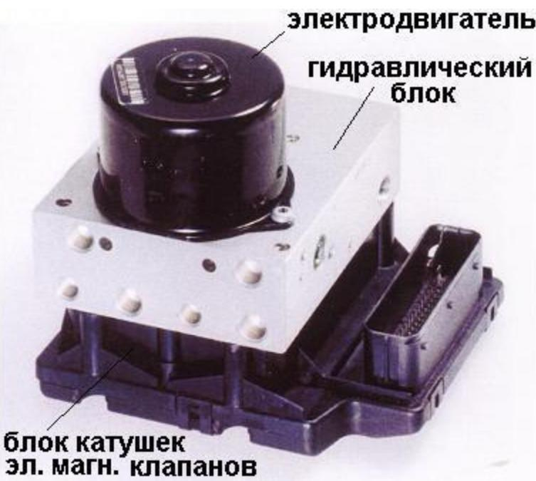
На автомобили JM устанавливаются ESP модели MGH-25 разработки компании MANDO Corp. В нём обе части
