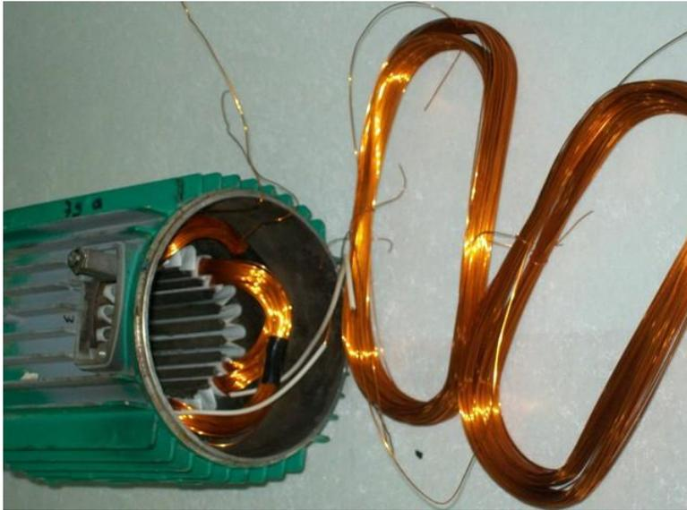
Начала и концы фаз выводятся к шести зажимам для того, чтобы можно было подключать обмотку статора по схеме «звезда» или «треугольник». При последовательном согласном соединении каждые три катушки дают пару полюсов.
