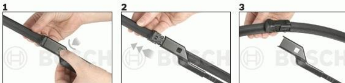
Установка дворников с креплением "Push-button"
