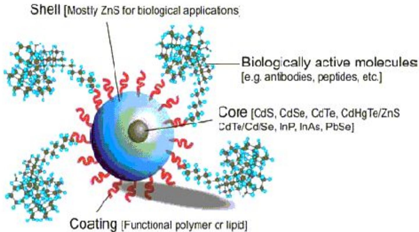
В центре комплекса находится полупроводниковая КТ, способная флуоресцировать. Окружающая квантовую точку «шуба» снижает токсичность полупроводниковых материалов и является своеобразным якорем, на который крепятся антитела, пептиды и другие органические соединения.
