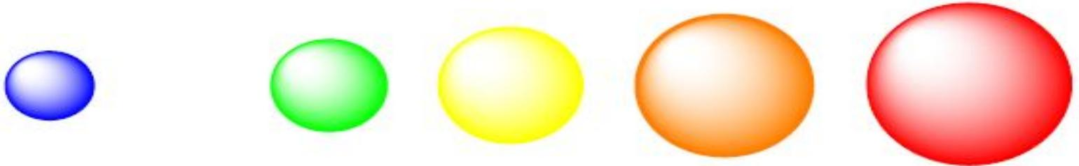
С увеличением радиуса квантовых точек от 5 до 20 nm в серии используемых полупроводниковых материалов длина волны излучения увеличивается от 400 до 1003 nm.
