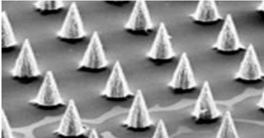
Нанопластырь делает укол: на поверхности кремниевой пластины сантиметрового размера расположены тысячи микроскопических тонких выступов, покрытых наночастицами с инкапсулированной вакциной.
