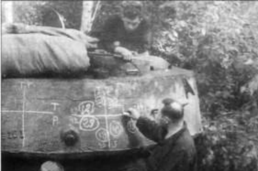
Центрування двигуна з коробкою передач танку Т-34-85
