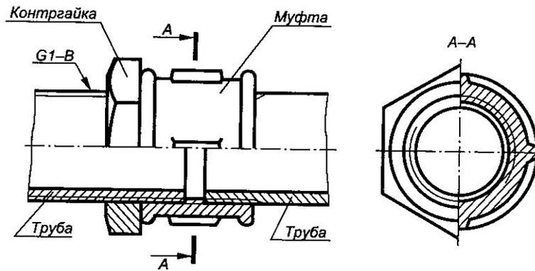
Трубное соединение выполняется в двух изображениях: главный вид представляет собой сочетание половины вида с фронтальным разрезом, а вид слева — сочетание половины вида с профильным разрезом.
