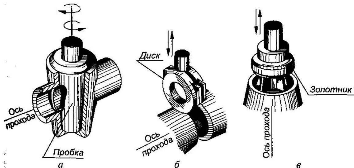
**Арматурой** называются различные устройства, которые осуществляют изменение площади прохода трубопровода, а также направления движущейся в нем среды (жидкости, газа, пара). Изменение площади прохода достигается перемещением в корпусе арматуры **затвора**, перекрывающего проход.
