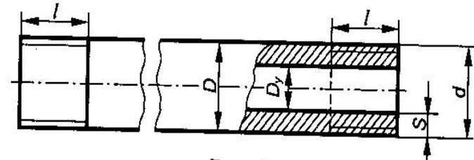
Параметры трубы определяют по диаметру условного прохода  $D_y$ , который приблизительно равен внутреннему диаметру трубы.
