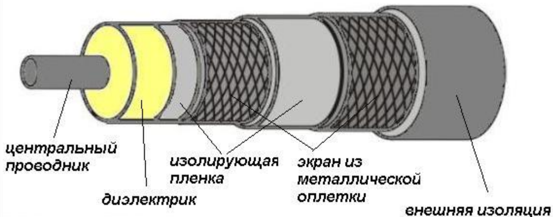
кабель с двойным экранированием
