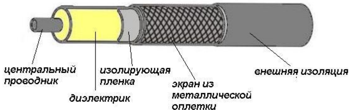
кабель с одинарным экранированием
